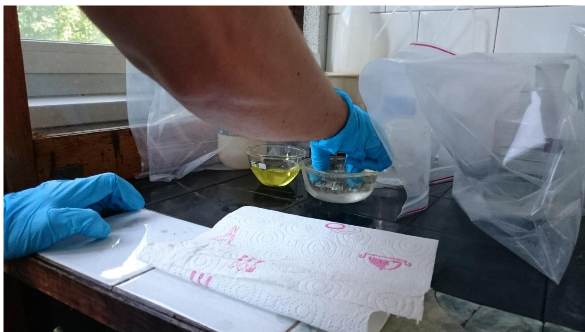
Slika 54. Nagrčanje priprema u Nitalu
