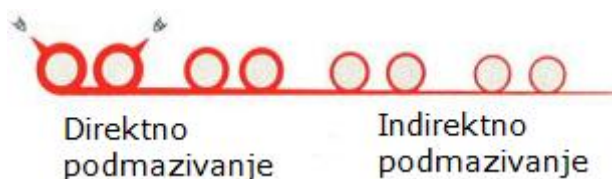
Slika 37. Razlika direktnog i indirektnog podmazivanja
