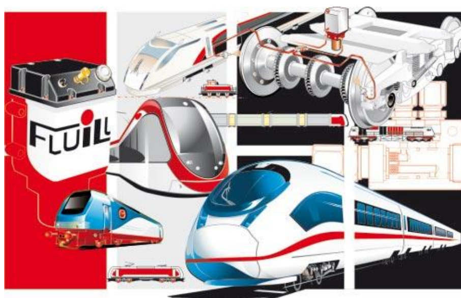
Slika 35. Podmazivanje vijenca kotača pomoću FluiLub sustava
