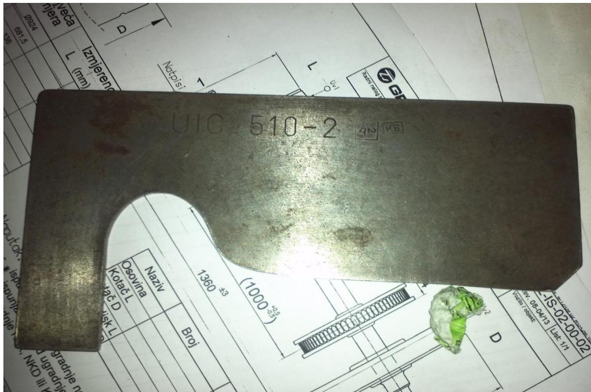
*Slika 31. Mjerka za kontrolu vijenca i profil kotača*
