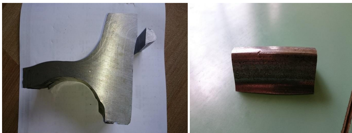
Slika 47. Izrezani vijenac monoblok kotača
