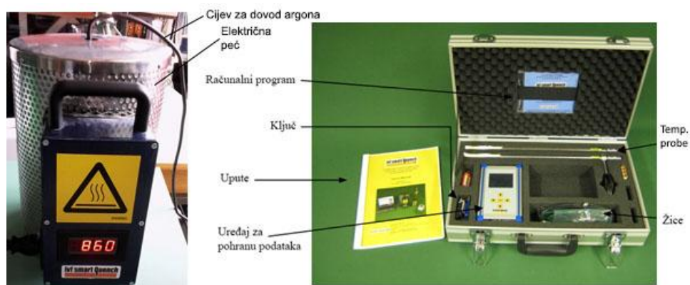
Slika 51. IVF Smart Quench oprema za ispitivanje krivulja hlađenja kapljevutih sredstava za gašenje [17]
