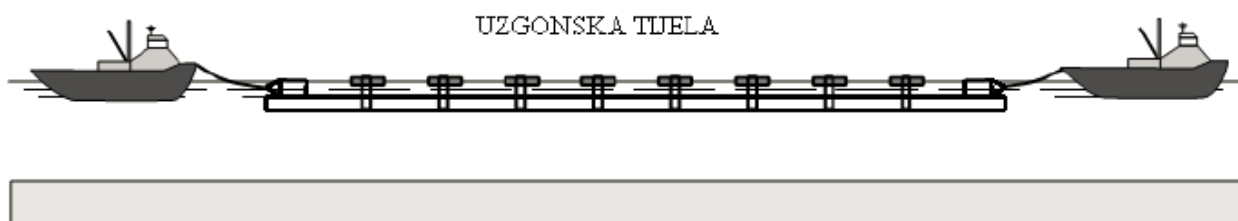
Slika 6. Metoda povlačenja cjevovoda po površini [2]
