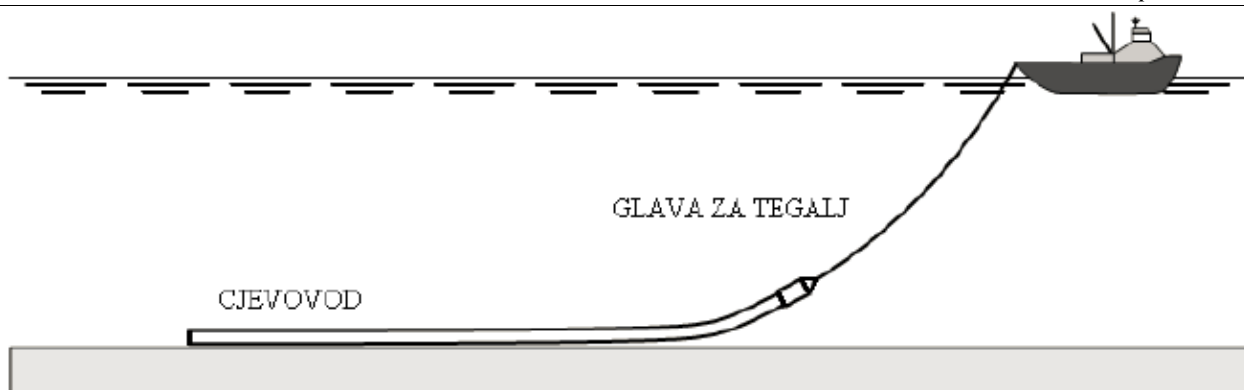
Slika 4. Metoda povlačenja po dnu [2]
