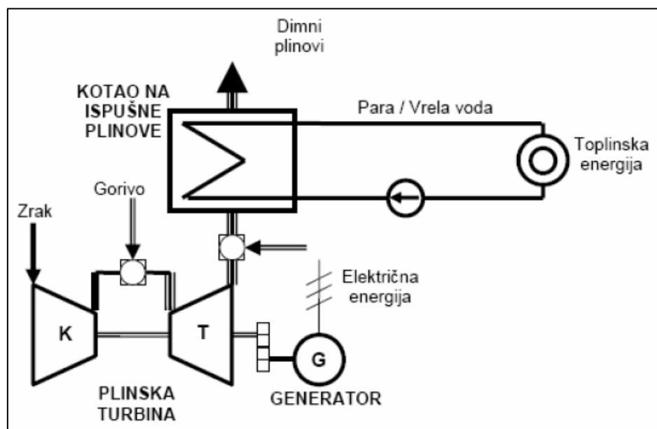
Slika 16. Shema kogeneracijskog postrojenja s kotлом na otpadnu toplinu [3]
