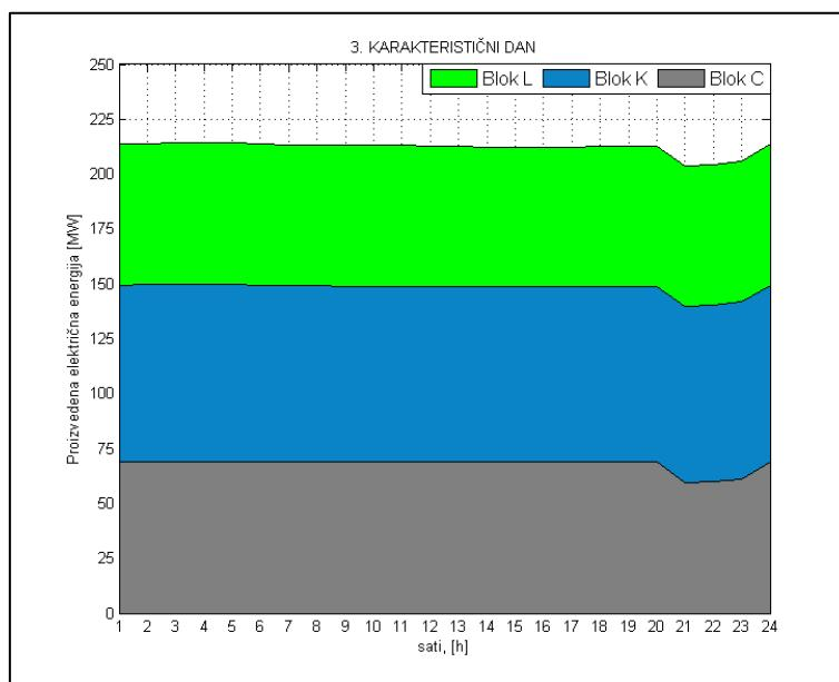
**Slika 56. Proizvodnja električne energije u trećem karakterističnom danu**
