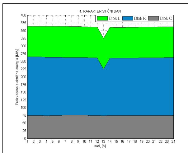
**Slika 82. Proizvodnja električne energije u četvrtom karakterističnom danu**
