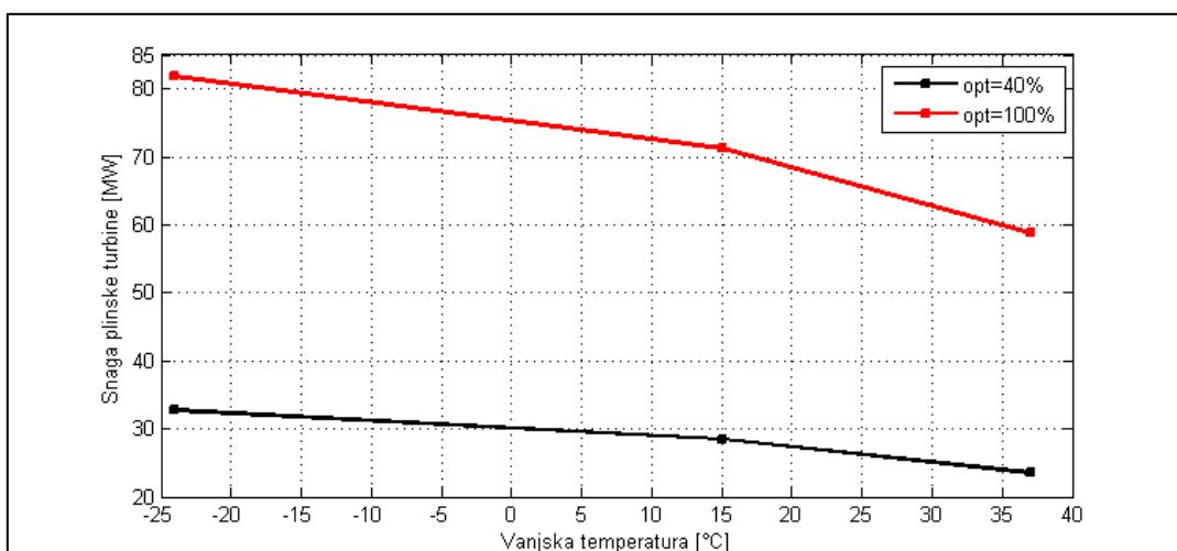
Slika 26. Snaga plinske turbine bloka K u ovisnosti o vanjskoj temperaturi i opterećenju
