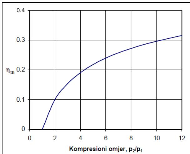
**Slika 9. Stupanj iskoristivosti u ovisnosti o kompresijskom omjeru**
