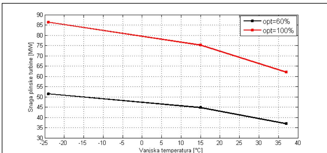
Slika 33. Snaga plinske turbine bloka L u ovisnosti o vanjskoj temperaturi i opterećenju
