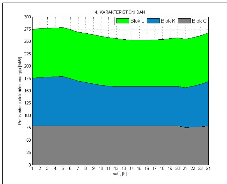
**Slika 70. Proizvodnja električne energije u četvrtom karakterističnom danu**
