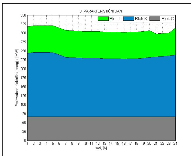
**Slika 44. Proizvodnja električne energije u trećem karakterističnom danu**
