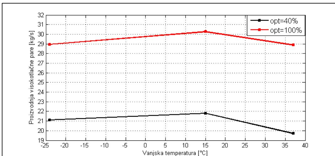
Slika 23. Proizvodnja visokotlačne pare bloka K u ovisnosti o vanjskoj temperaturi i opterećenju
