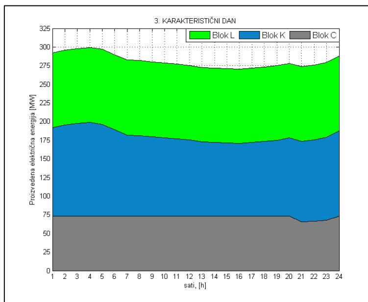
**Slika 68. Proizvodnja električne energije u trećem karakterističnom danu**
