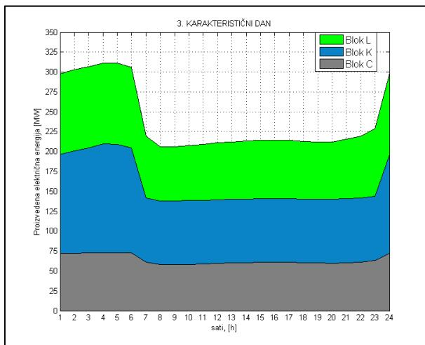
**Slika 80. Proizvodnja električne energije u trećem karakterističnom danu**
