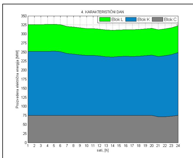
**Slika 46. Proizvodnja električne energije u četvrtom karakterističnom danu**
