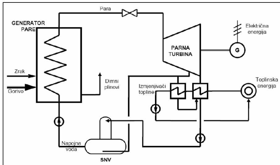
Slika 14. Shema kogeneracijskog postrojenja s protutlačnom parnom turbinom [3]
