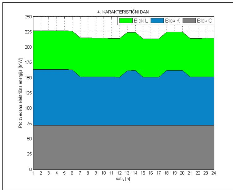
**Slika 58. Proizvodnja električne energije u četvrtom karakterističnom danu**
