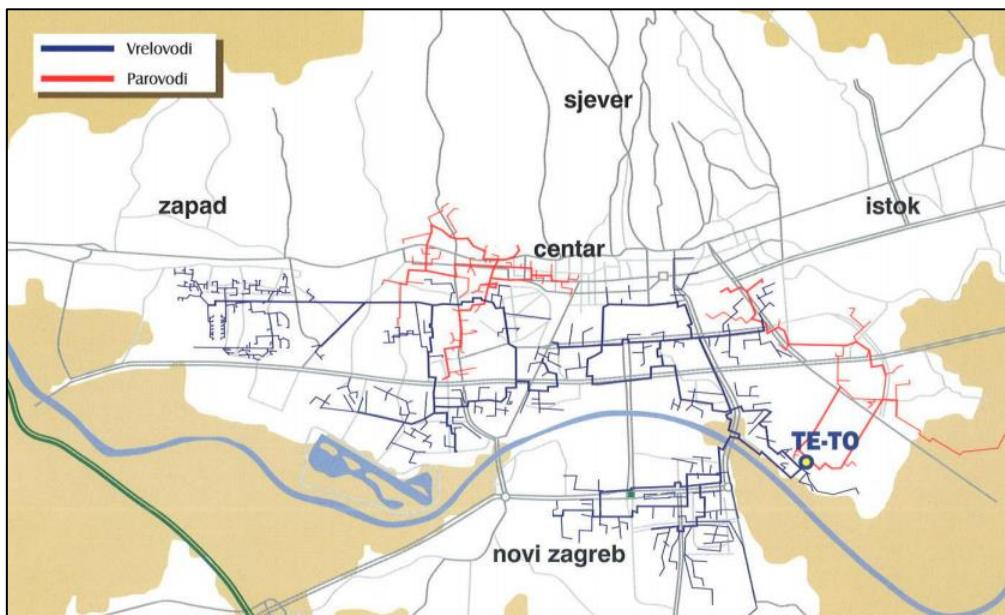
Slika 17. Smještaj TE-TO i raspored vrelovoda i parovoda
