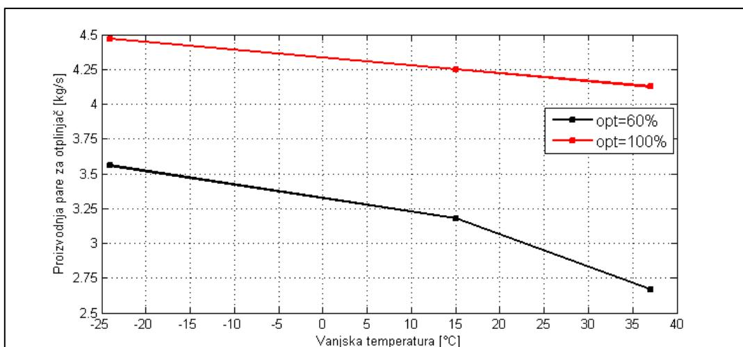
Slika 31. Proizvodnja pare za otplinjač bloka L u ovisnosti o vanjskoj temperaturi i opterećenju
