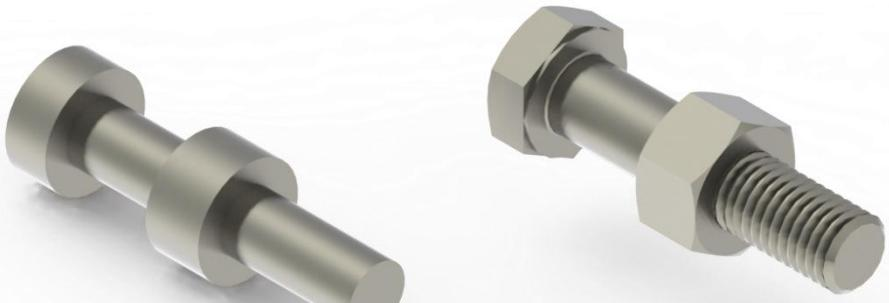
**Slika 11 –** Pojednostavljenja vijka i matice M10
