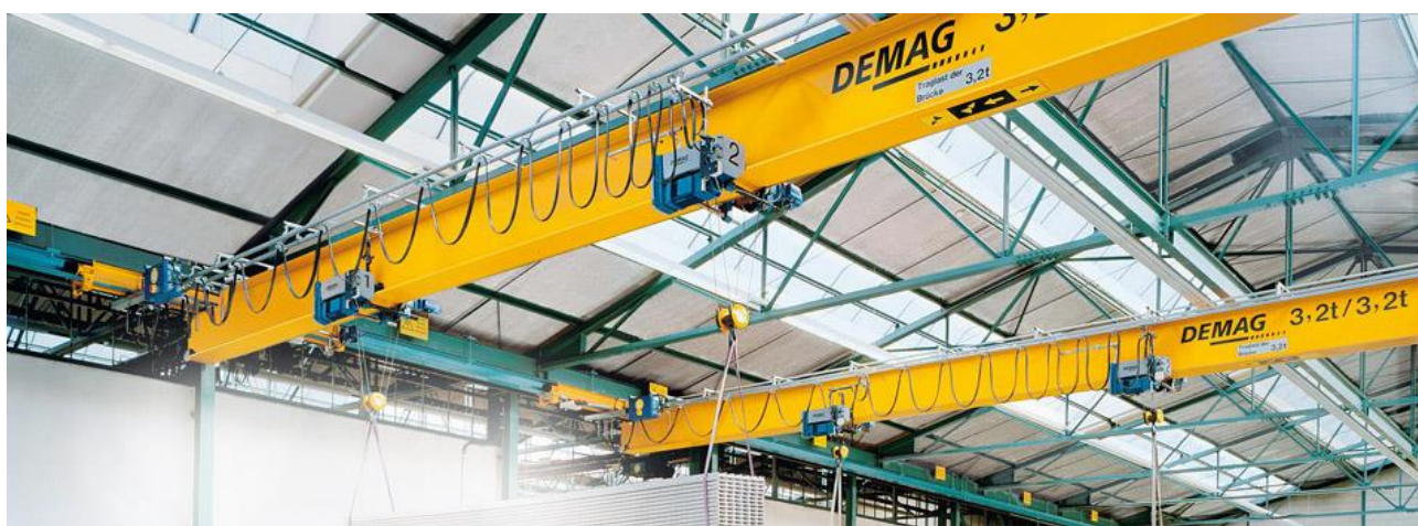
Slika 2.3. Mosni granik s jednim glavnim nosačem [11]
