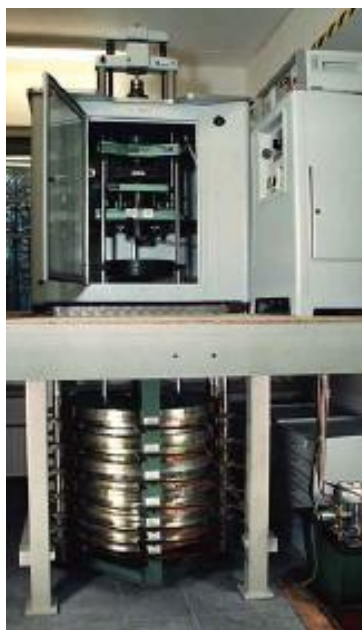
Slika 2.3 Primarni etalon tvrdoće u PTB-u [20]
