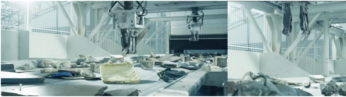
Slika 30. Manipulator za uklanjanje otpada lijevo, desno je prikazana hvataljka [40]
