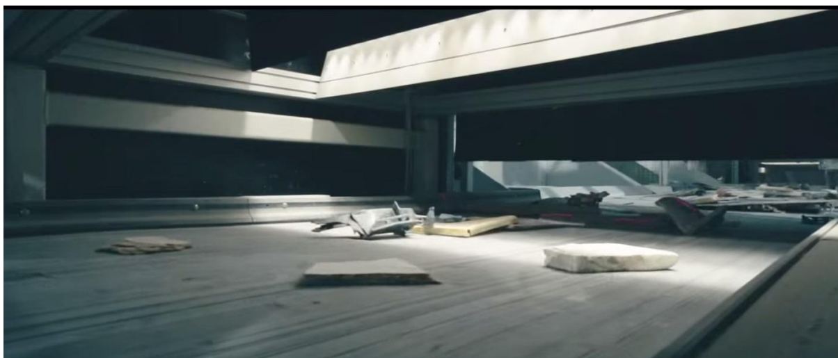
Slika 29. Optički uređaj za sortiranje otpada [40]
