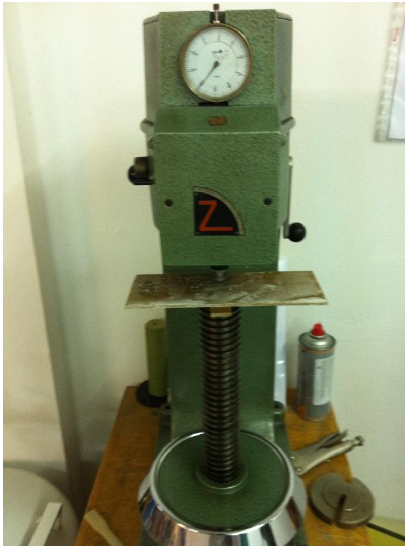
Slika 13. Ispitivanje tvrdoće na tvrdomjeru Zwick 3106
