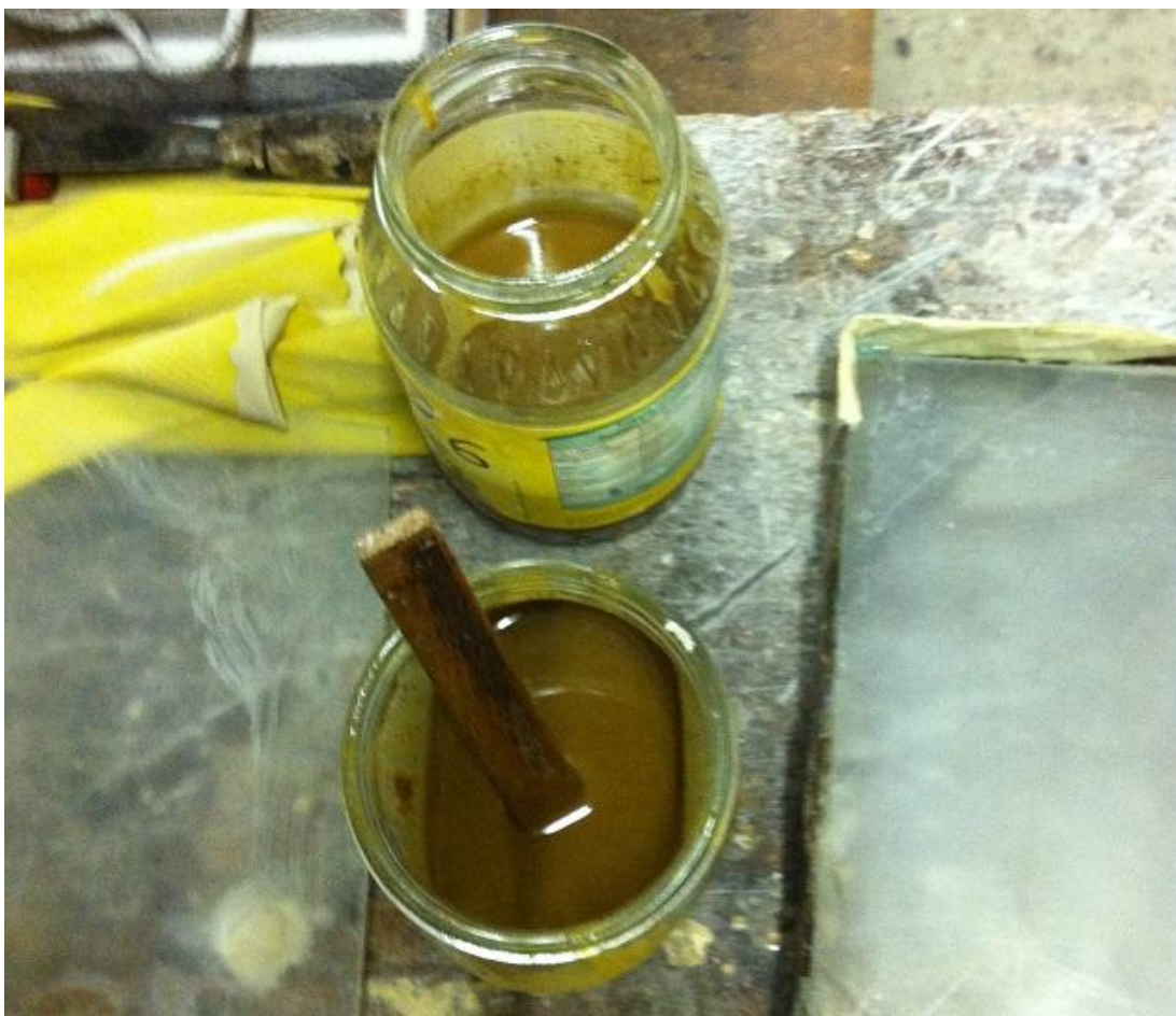
Slika 17. Suspenzija poliesterske smole i čestica jarosita nakon provedene homogenizacije i dispergiranja ultrazvučnom sondom
