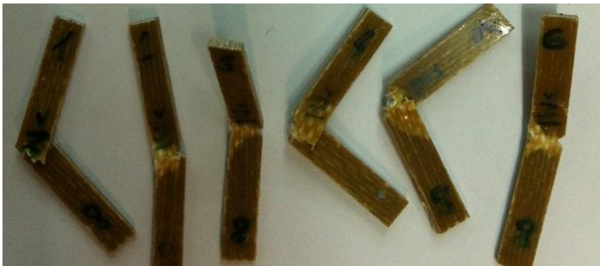
Slika 30. Uzorci nakon ispitivanja udarne žilavosti
