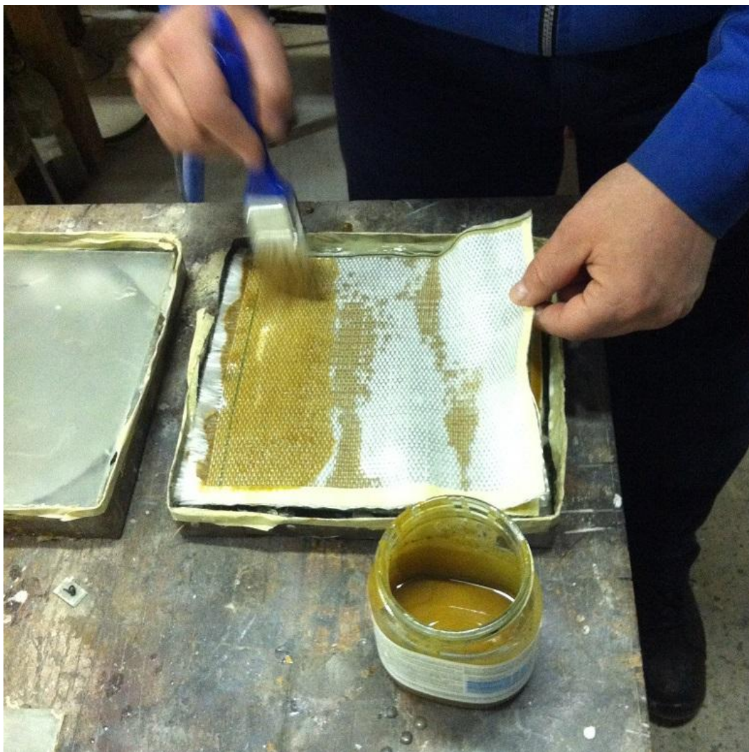
Slika 19. Izrada kompozita od poliesterske smole sa dodatkom čestica jarosita kao punila i ojačanja staklenih vlakana tehnikom ručnog laminiranja
