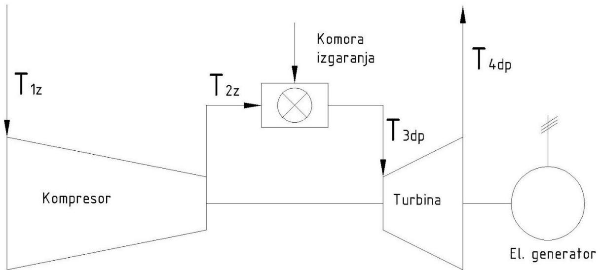
Slika 10. Shematski prikaz plinsko turbinskog procesa
