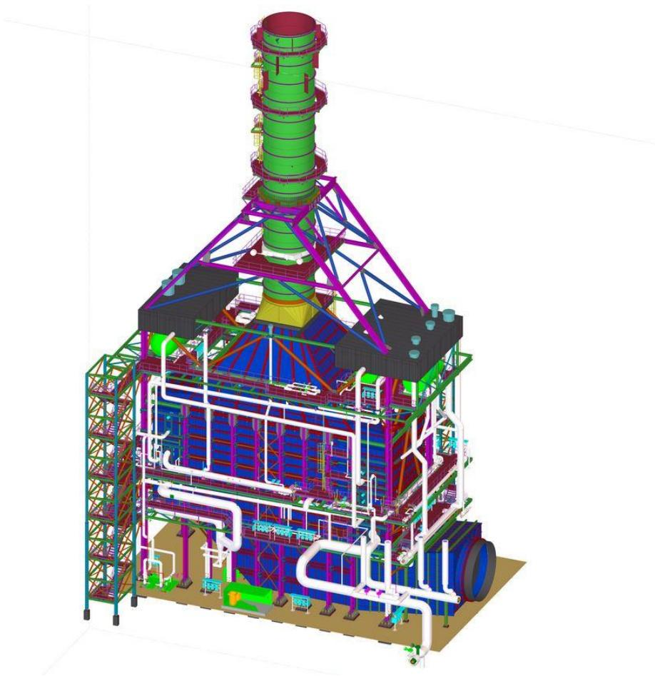
Slika 13. Primjer kotla na otpadnu toplinu HRSG[10]
