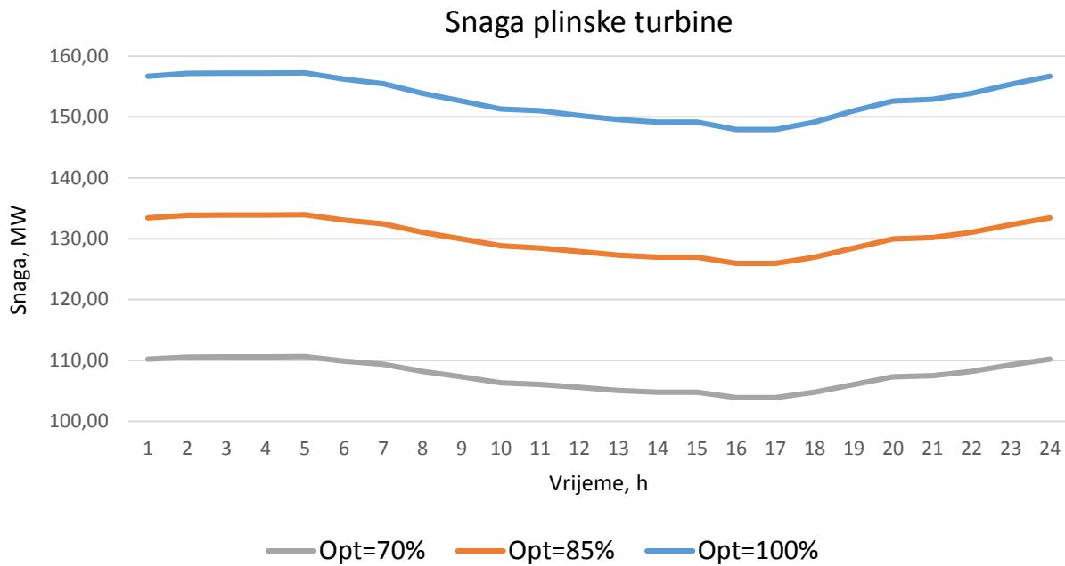
**Slika 30. Snaga plinske turbine za karakterističan dan prijelaznog perioda**
