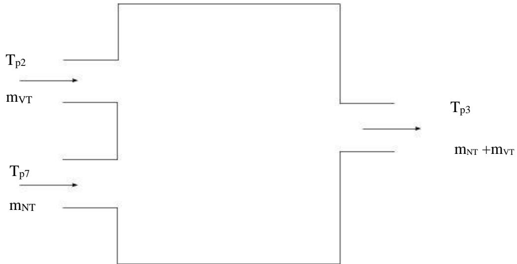
**Slika 17. Shema mješališta nakon visokotlačnog dijela parne turbine**
