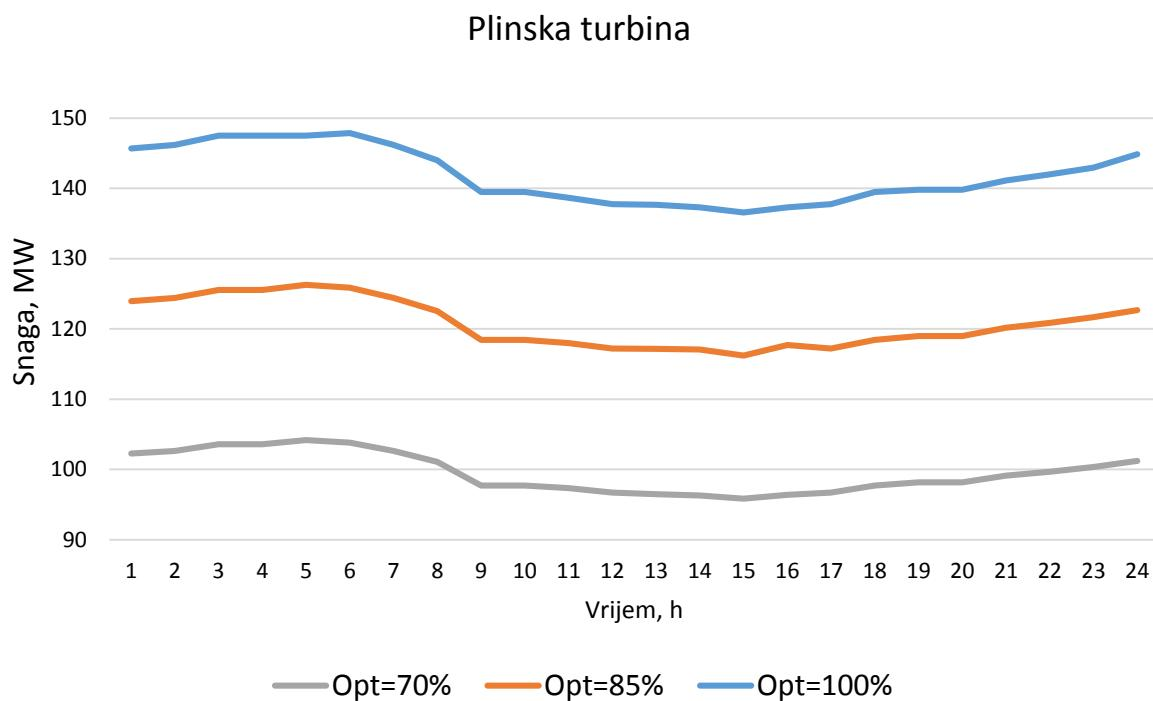
**Slika 22. Snaga plinske turbine za karakterističan dan ljetnog perioda**
