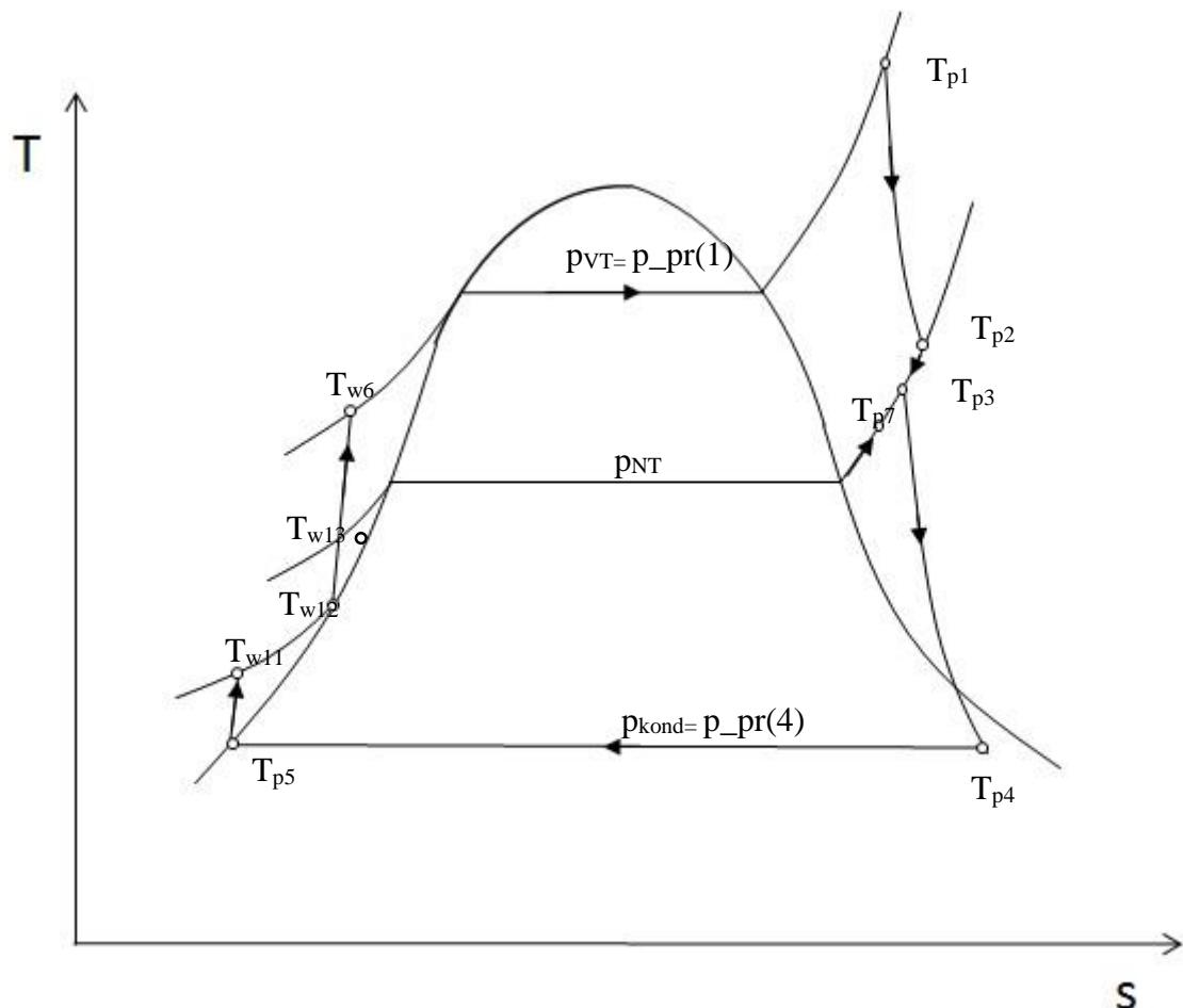
**Slika 16.** T-s dijagram parnoturbinskog procesa s pripadajućim temperaturama
