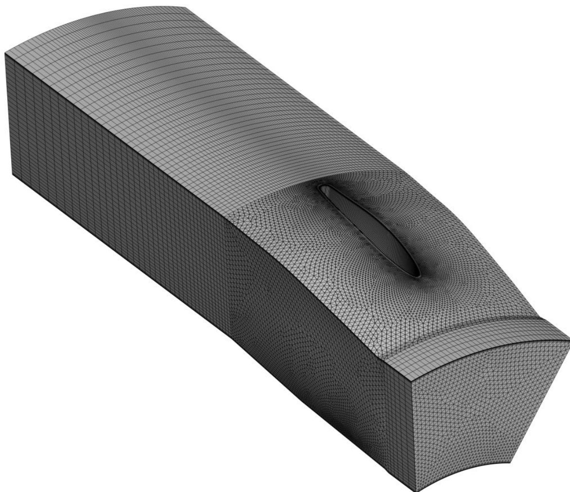
Slika 11. Vidljiva – površinska disretizacija domene fluida
