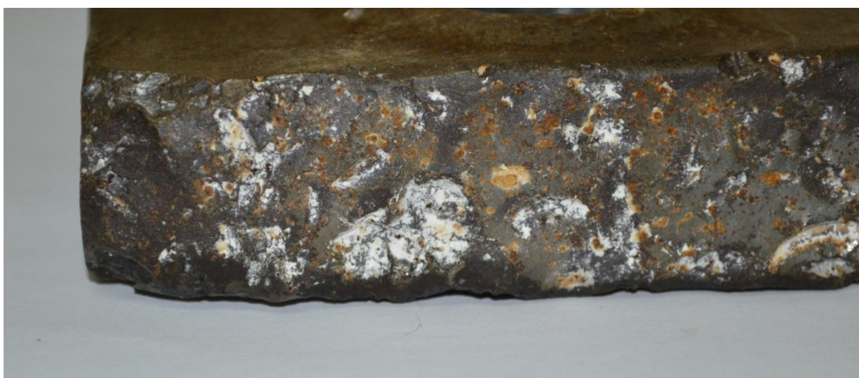
Slika 45. Tragovi trošenja kidanjem materijala
