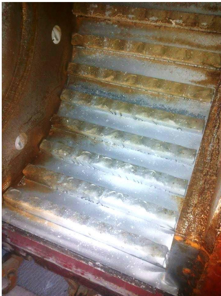
Slika 49. Tragovi trošenja na gornjim udarnim oblogama
