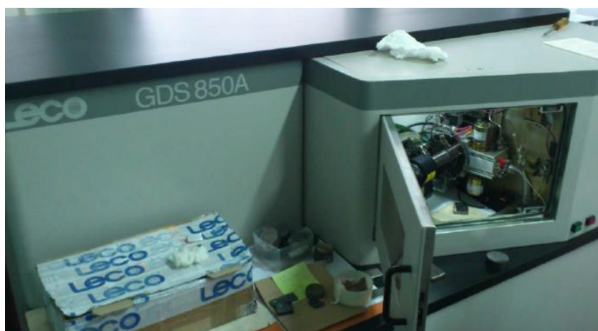
Slika 51. Optički emisijski spektrometar LECO GDS 850A
