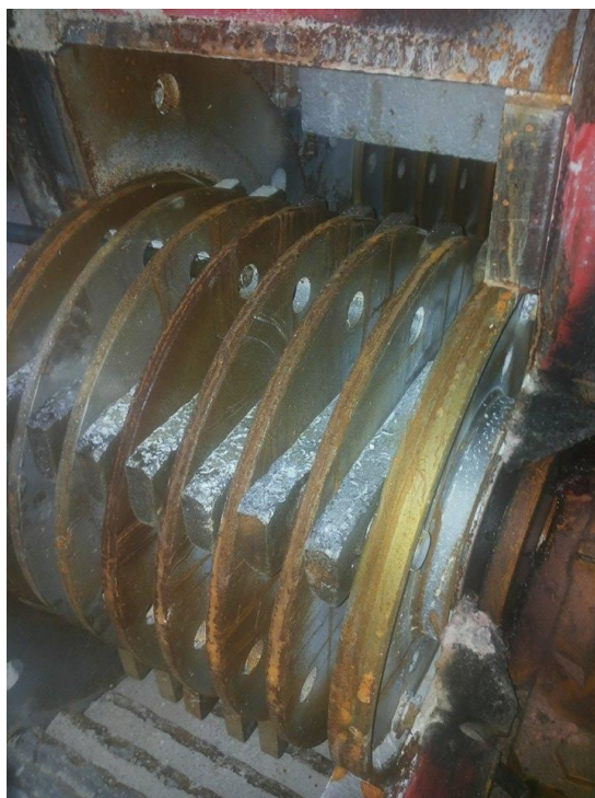
Slika 30. Rotor s čekićima i udarne obloge
