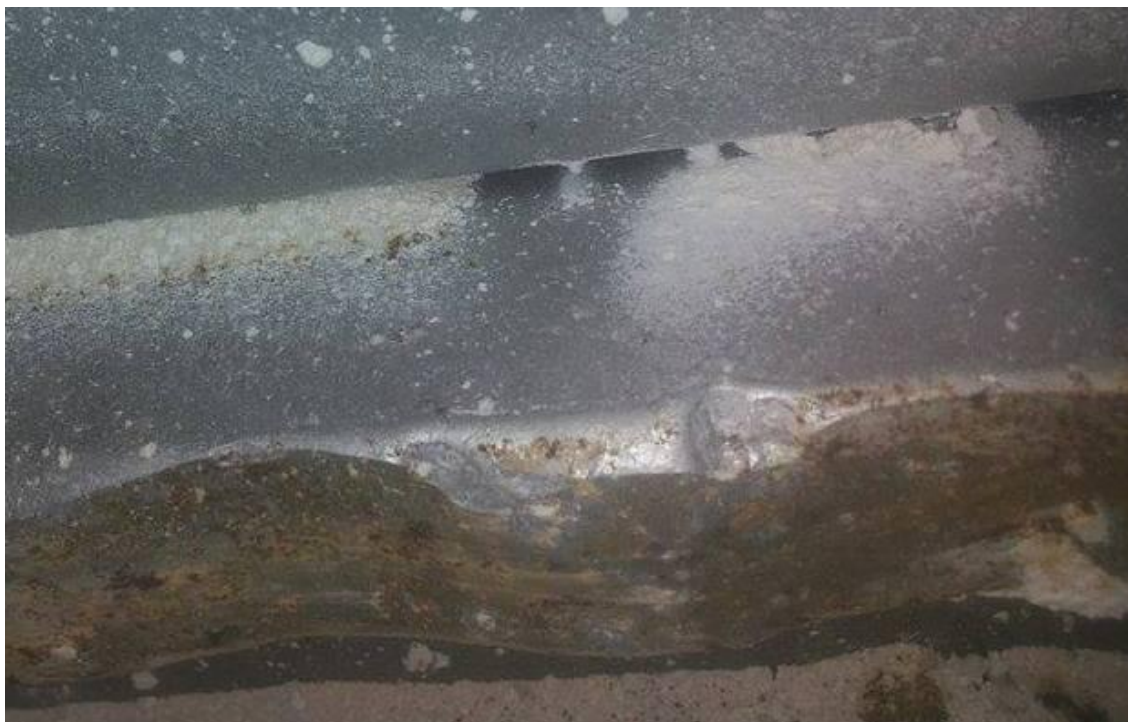
Slika 48. Tragovi trošenja na udarnim oblogama, detalj
