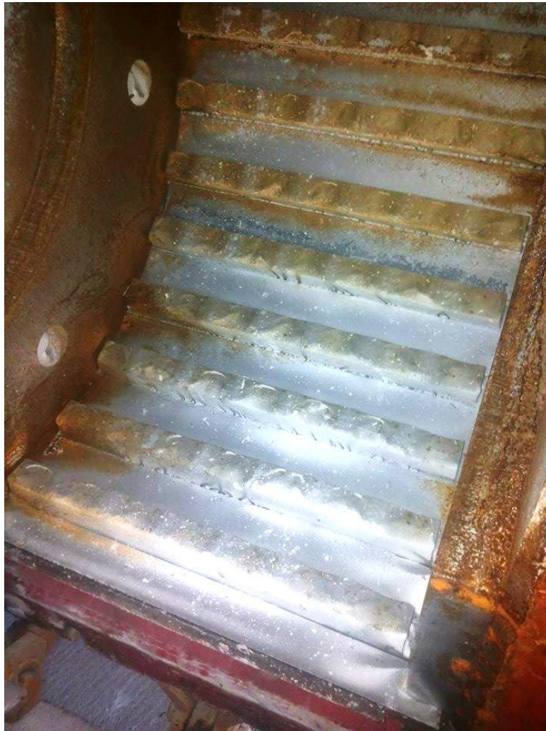
Slika 49. Tragovi trošenja na gornjim udarnim oblogama
