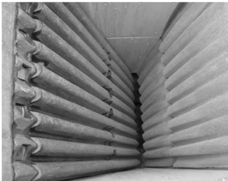
Slika 14. Radne ploče čeljusne drobilice [4]
