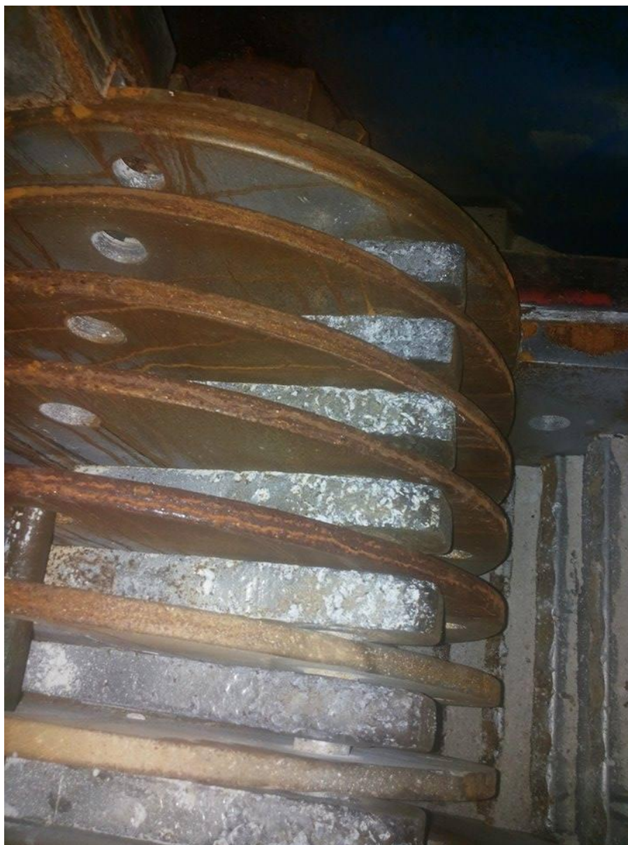
Slika 34. Čekići na rotoru i udarna pruga – elementi najizloženi trošenju
