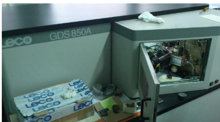
Slika 51. Optički emisijski spektrometar LECO GDS 850A
