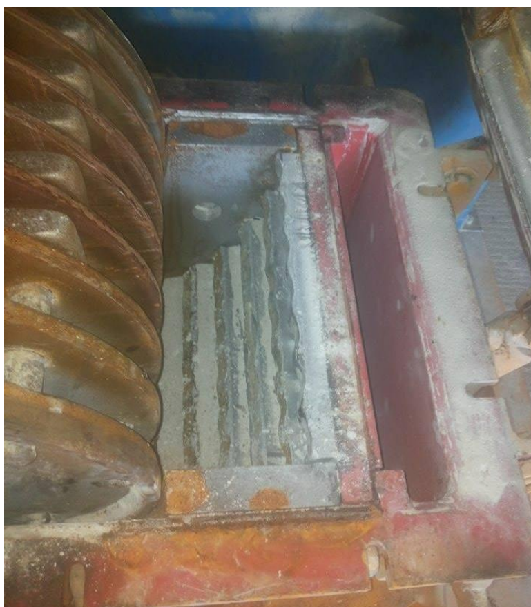
Slika 46. Udarne obloge ispod rotora u kućištu mlina
