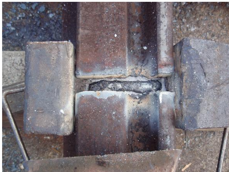
Slika 5.12. Zavar u fazi izrade (uzorak 6) s velikom količinom zaostale troske po rubovima
