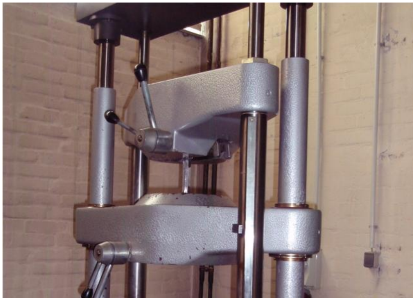
Slika 5.29. Stati ki vla ni pokus
