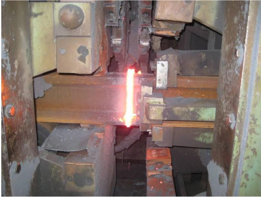
Slika 3.3. Zavarivanje tra nica iskrenjem [9]
