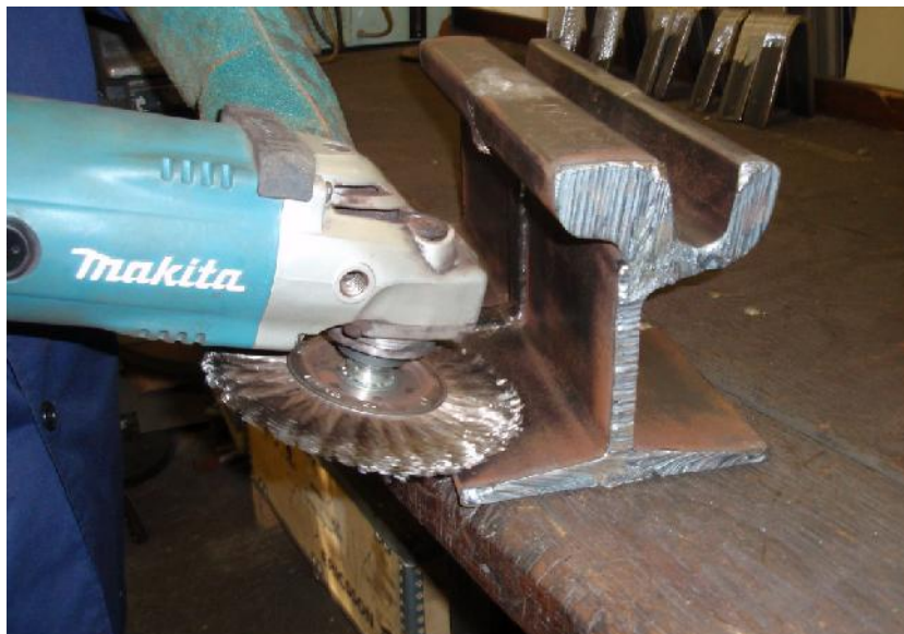
Slika 5.1. Dodatno mehaničkočišćenje uzoraka
