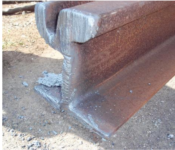
Slika 4.3. Tra nica odrezana ru nim plinskim postupkom
