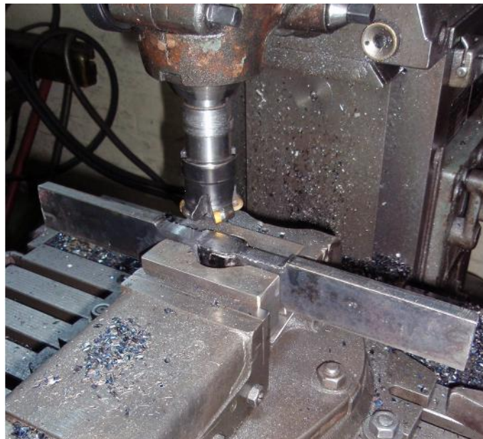
Slika 5.15. Glodanje epruvete za statički vlačni pokus
