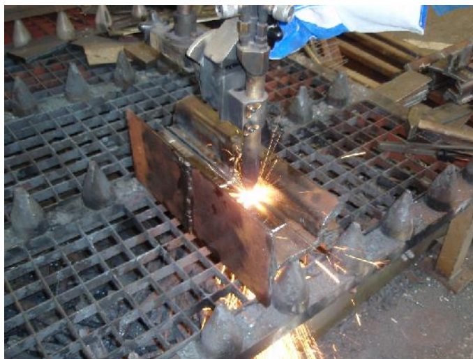
Slika 5.13. Rezanje uzoraka automatiziranim plinskim postupkom
