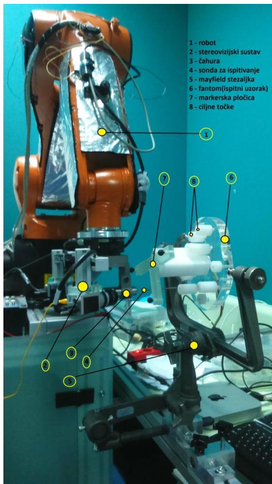
**Slika 17. Postupak ispitivanja**
