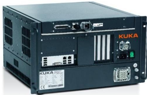
**Slika 26.** Upravljačka jedinica KUKA KR C4 compact
