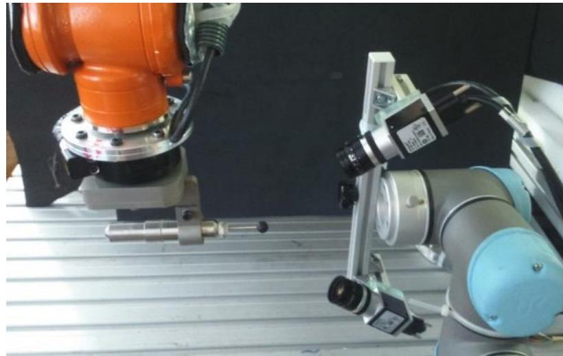
**Slika 40. Kalibracija alata pomoću vizijskog sustava**
