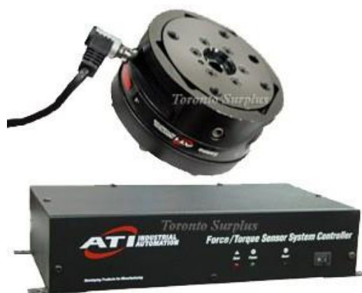
Slika 32. Senzor sile i momenta ATI Gamma
