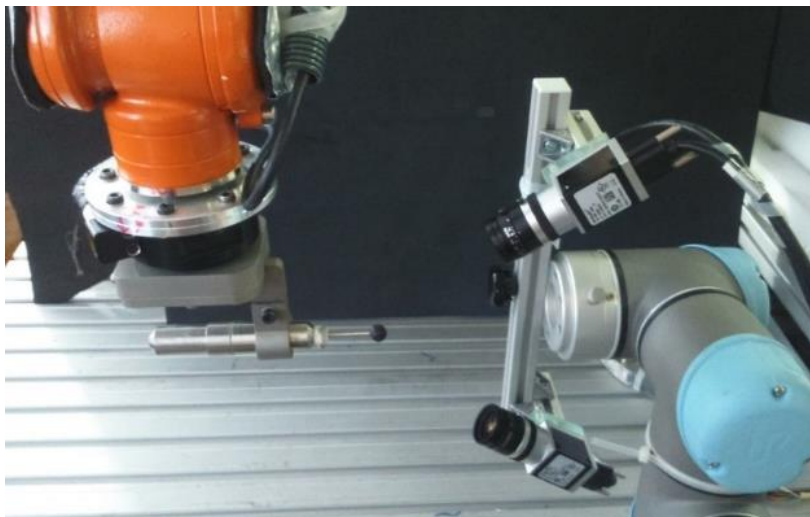
Slika 40. Kalibracija alata pomoću vizijskog sustava
