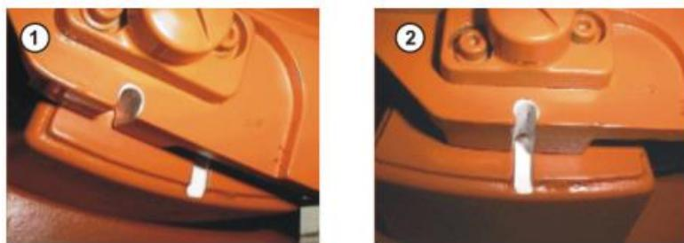
**Slika 43. Pomicanje robotske osi do njezinog početnog položaja**
