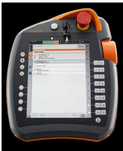
Slika 27. Upravljačko sučelje KUKA smartPAD
