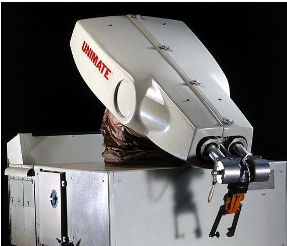
Slika 1. UNIMATE – prvi industrijski robot
