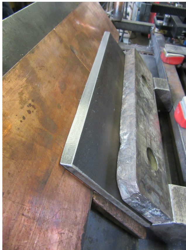
Slika 30 Konfiguracija zavarivanja međusloja, bočna strana
