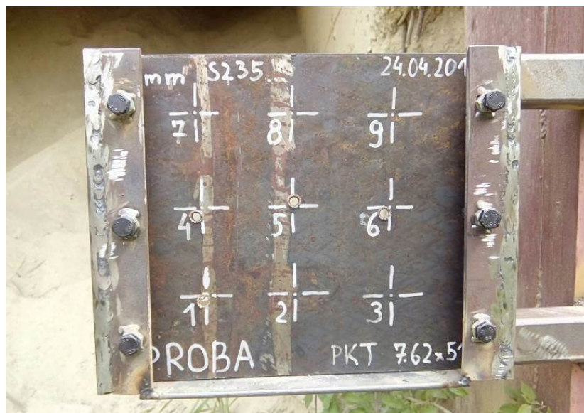
Slika 36 Probna meta učvršćena u noseći okvir
