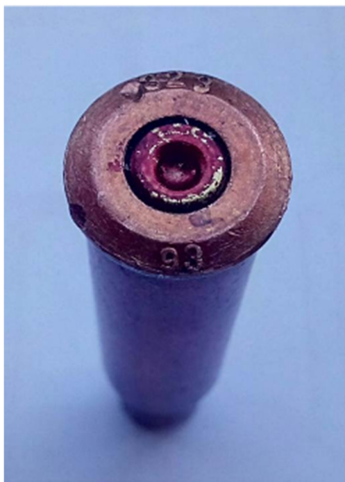
Slika 34. Čahura iskorištenog standardnog metka 7,62x51 s bakrenom košuljicom
