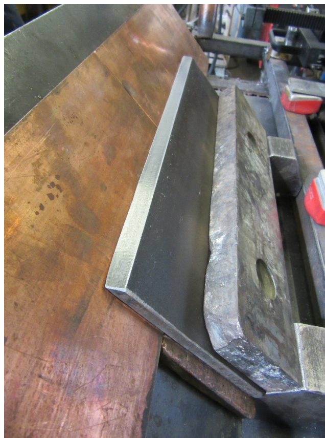
Slika 30 Konfiguracija zavarivanja međusloja, bočna strana
