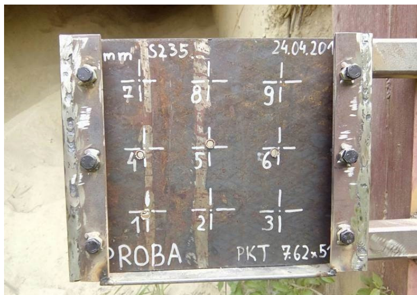
Slika 36 Probna meta učvršćena u noseći okvir
