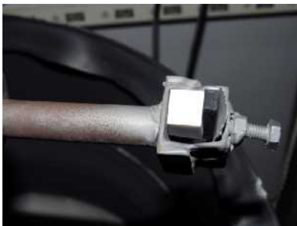
Slika 37. Uzorak na držaču ure aja za ispitivanje otpornosti na erozijsko trošenje [45].
