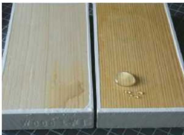
Slika 13. Povećanje hidrofobnosti drva obrađeno hidrofobnim imregnacijskim sredstvom (desno) u usporedbi s neobrađenim drvom (lijevo) [10].
