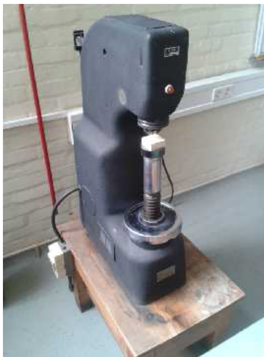
Slika 28. Postupak ispitivanja tvrdoće metodom po Brinell-u [37].
