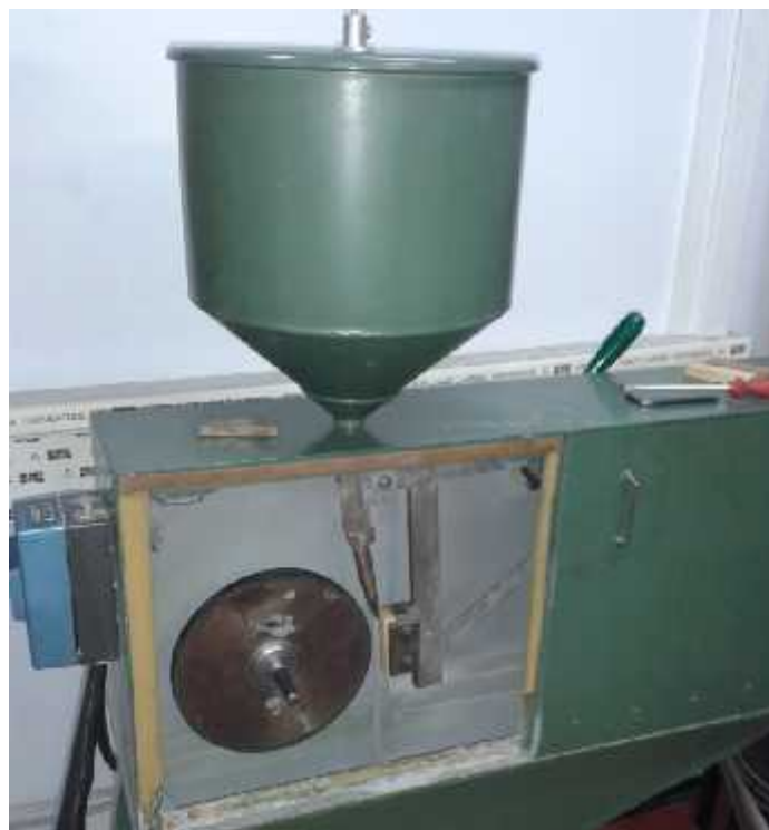
Slika 21. Uređaj za ispitivanje trošenja na abraziju [42].
