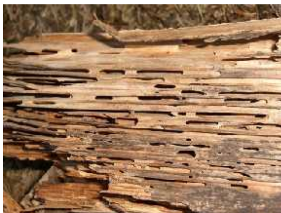
Slika 4. Primjer biološke degradacije nezašti enog drva [9].
