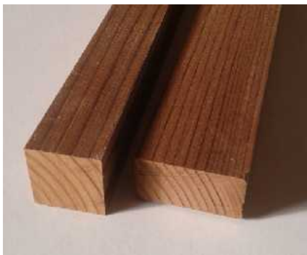
Slika 18. Izgled uzoraka od termotretirane borovine [37].
