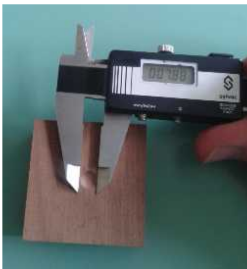
Slika 31. Mjerenje otiska kuglice digitalnim pomi nim mjerilom.
