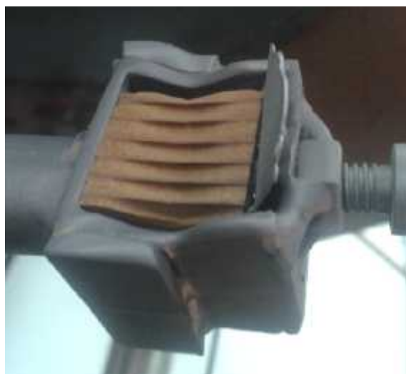
Slika 42. Izgled uzorka od modificirane borovine nakon erozijskog trošenja.
