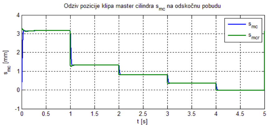
Slika 50. Odzivi pozicija klipova pogonskog i radnog cilindra na promjenjivu odskočnu referencu normalne sile
