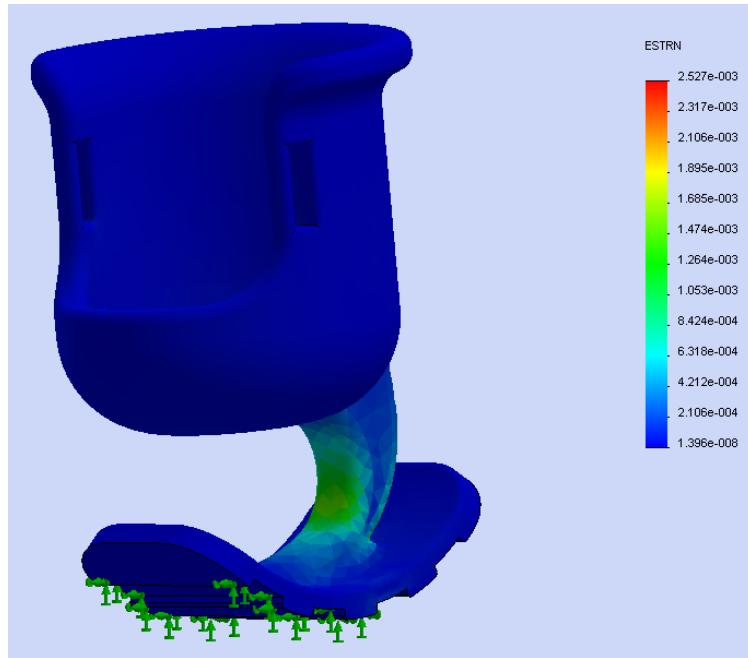
**Slika 51.** Ekvivalentna naprezanja po teoriji von Misesa
