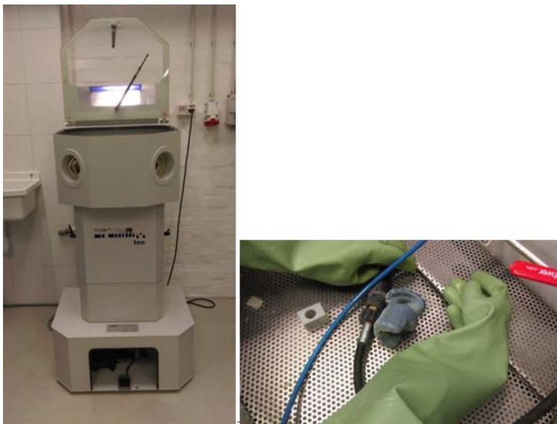
Slika 57. Uklanjanje potpornog materijala
