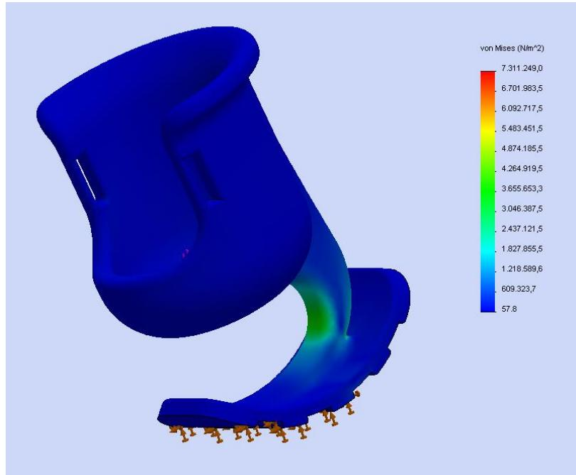
Slika 32. Naprezanje po teoriji von Misesa
