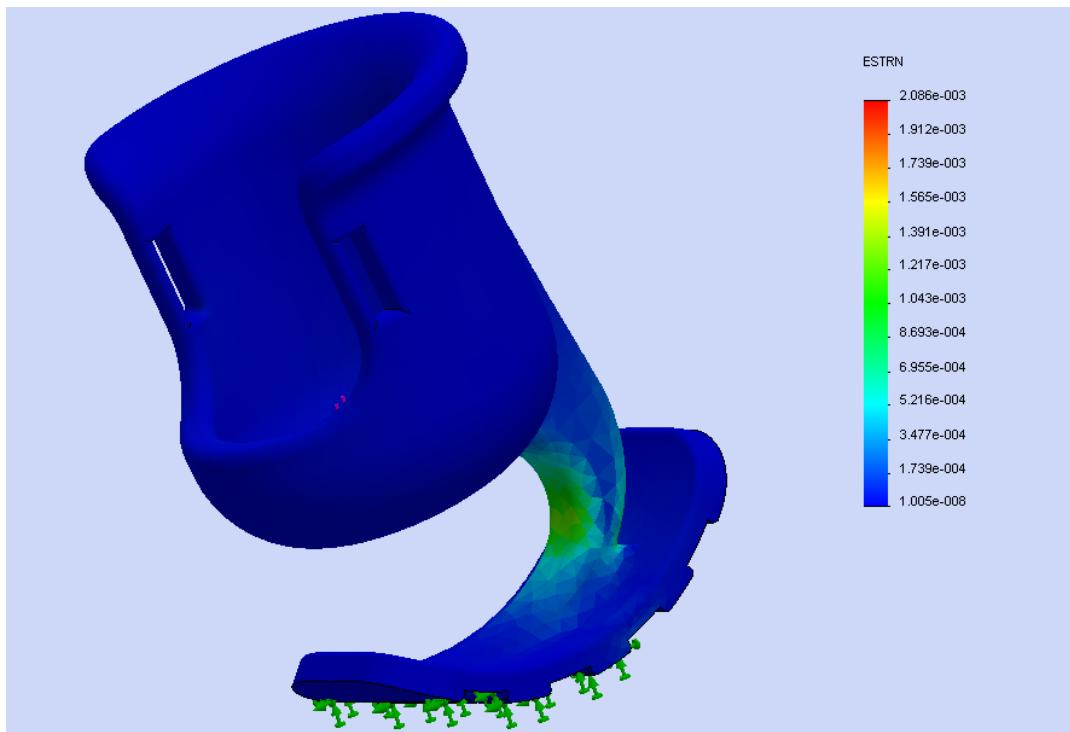
**Slika 35. Ekvivalentna naprezanja po teoriji von Misesa**
