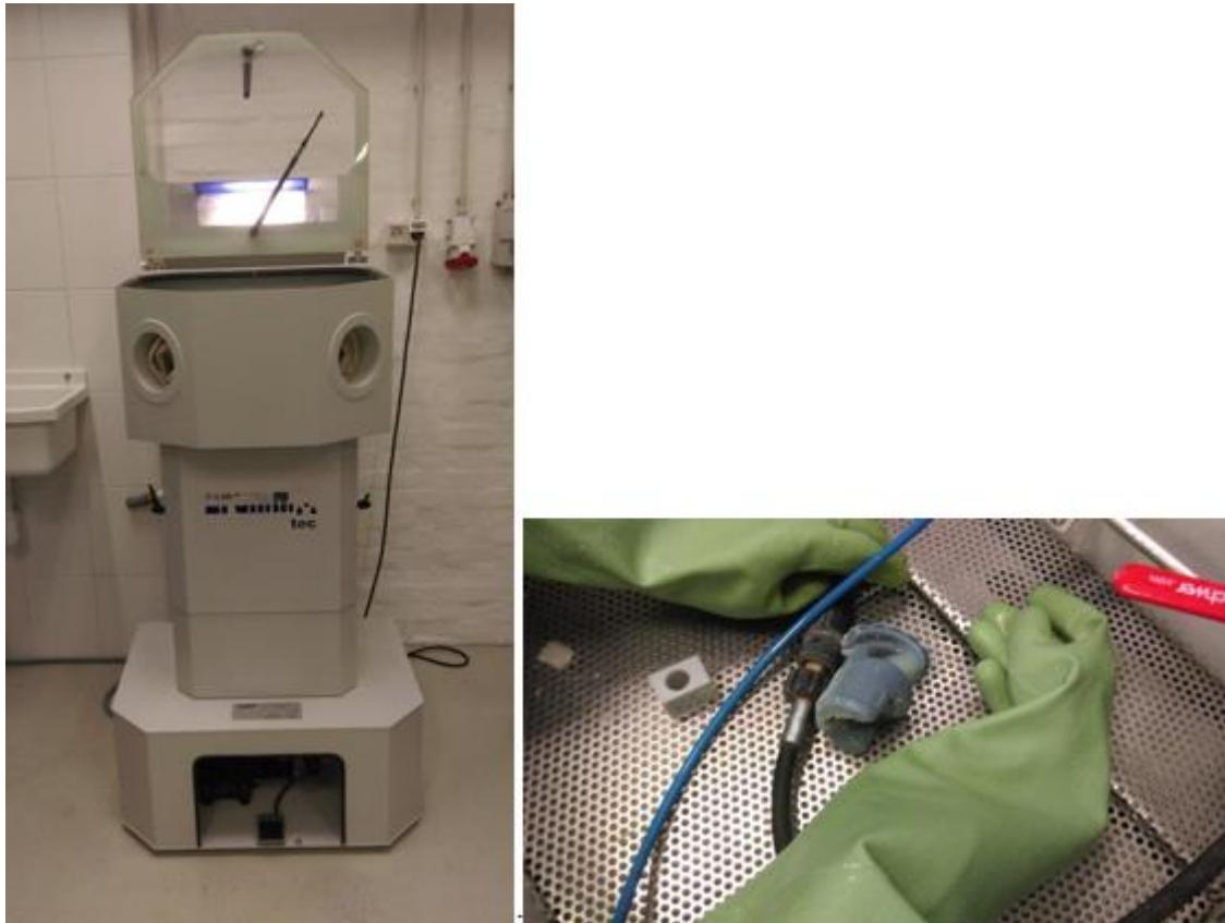
**Slika 57. Uklanjanje potpornog materijala**
