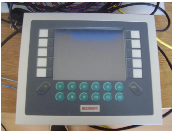
Slika 4.9 Industrijsko računalo proizvođača Beckhoff
