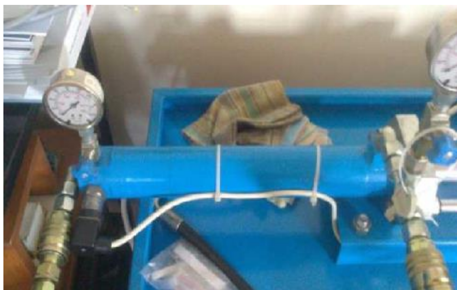
Slika 2.7 Pogonski dvoradni cilindar na laboratoriskom postavu
