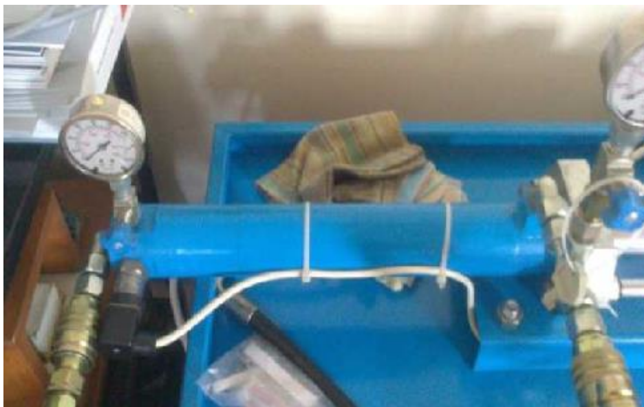
Slika 2.7 Pogonski dvoradni cilindar na laboratoriskom postavu
