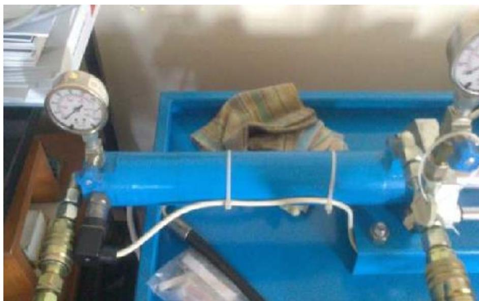
**Slika 2.7** Pogonski dvoradni cilindar na laboratoriskom postavu
