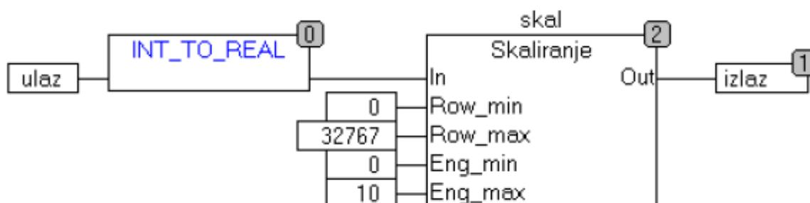
Slika 6.5 Skaliranje signala
