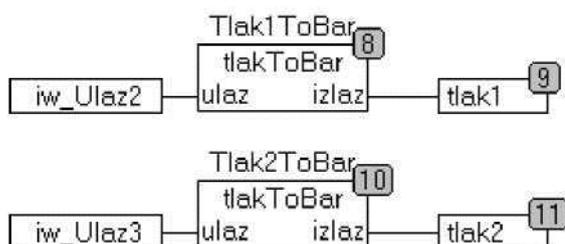
Slika 6.7 Obrada signala tlaka
