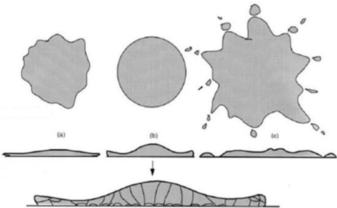
Slika 7. Prikaz deformiranja čestica praha pri udaru o površinu podloge [7]
