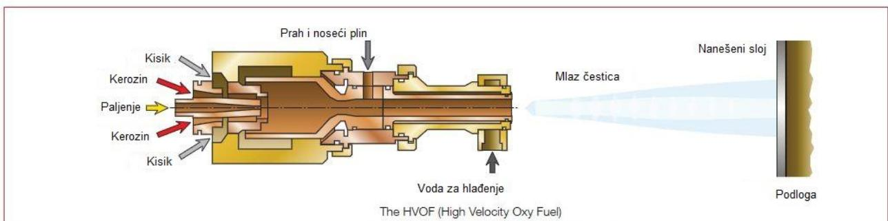
**Slika 15. Konstrukcije pištolja za HVOF ovisno o gorivu [21]**
