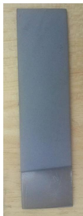
**Slika 23. Dobiveni uzorak  $\text{Cr}_3\text{C}_2$  prevlake HVOF postupkom naštrcavanja**
