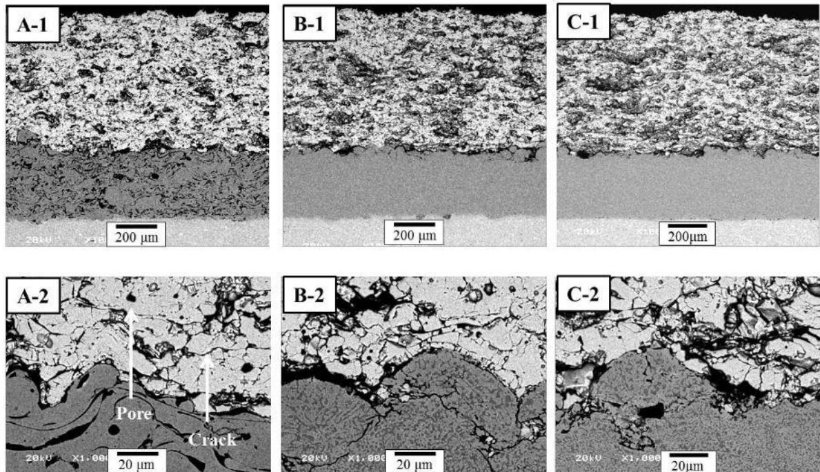
**Slika 20. Poprečni presjeci mikrostrukture TBC prevlake [16]**
