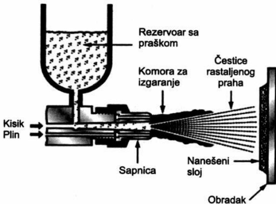
**Slika 14. Osnovni princip HVOF naštrcavanja [5]**
