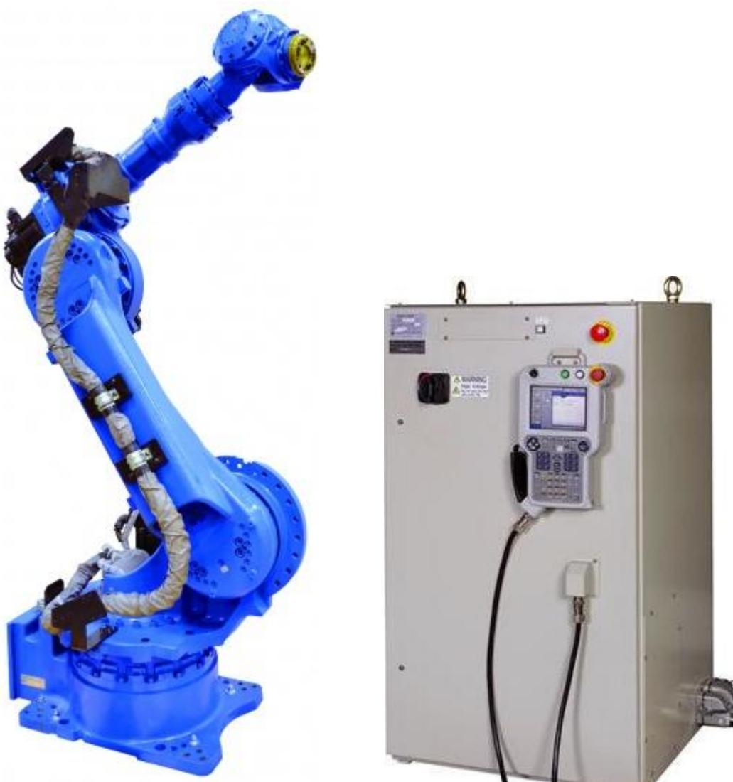
**Slika 21. Industrijski robot Yaskawa Motoman MC2000 s pripadajućim kontrolerom NX 100 koji je korišten za manipulaciju pištolja kod toplinskog naštrcavanja [36]**
