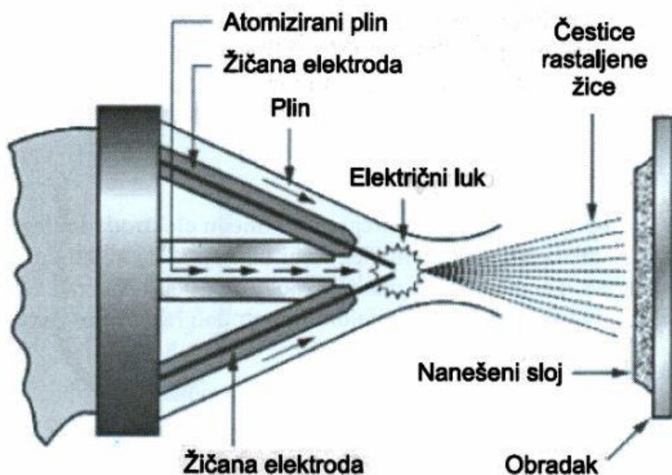
Slika 6. Shema postupka elektrolučnog naštrcavanja pomoću žice [5]
