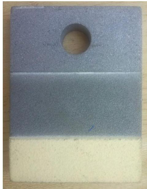
**Slika 22. Dobiveni uzorak TBC prevlake APS postupkom naštrcavanja**
