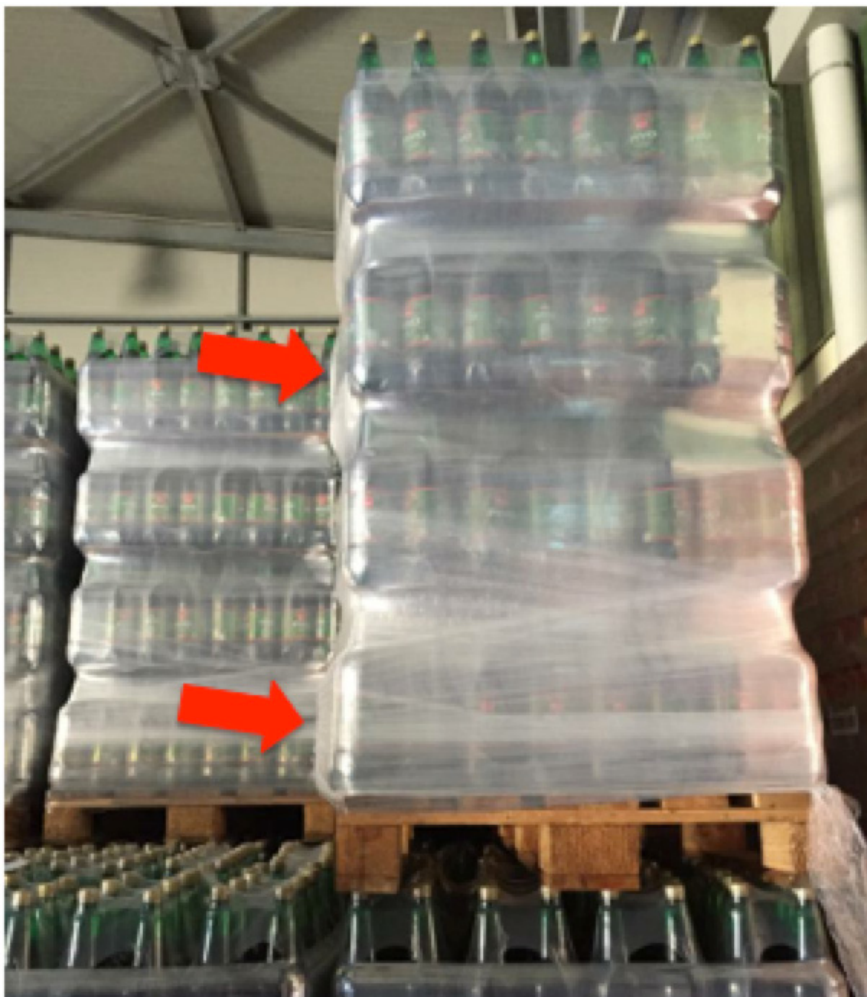
Slika 26. Kolumnno slaganje s vidljivom pojavom greškom
