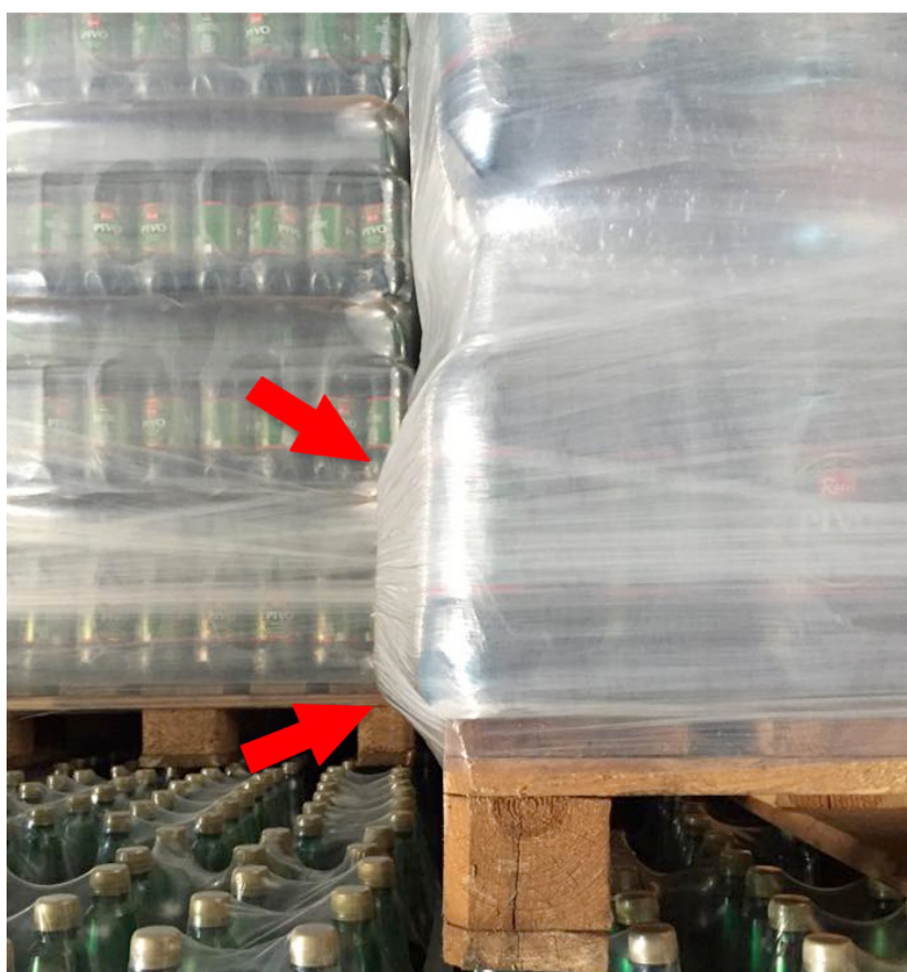
Slika 21. Greška prilikom slaganja na Euro paletu
