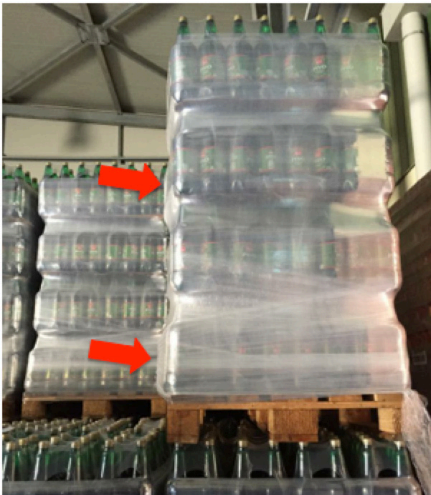
Slika 26. Kolumnno slaganje s vidljivom pojavom greškom
