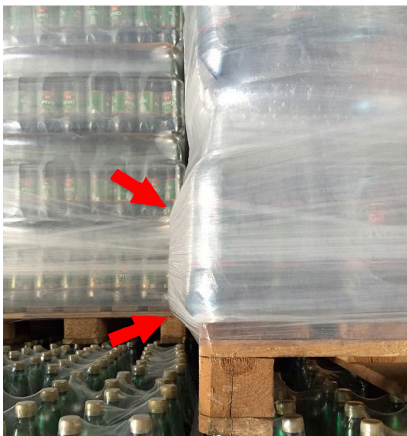
Slika 21. Greška prilikom slaganja na Euro paletu
