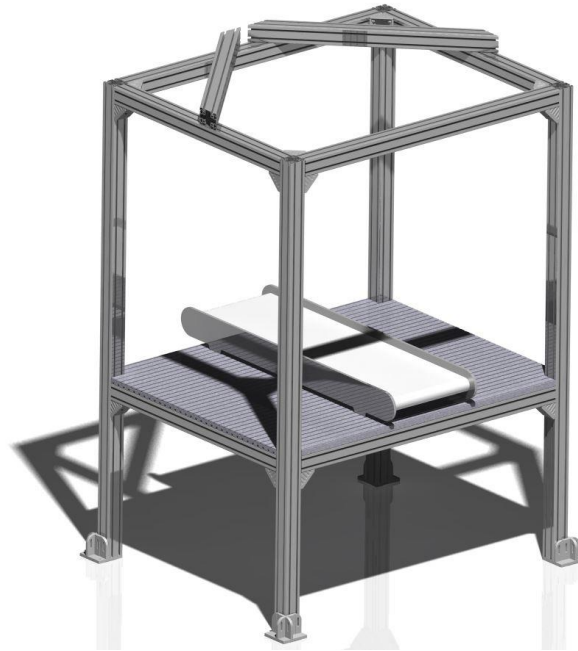
Slika 5. CAD model postolja Fanuc M3iA/6A robota sa pripadajućim transportnim sustavom
