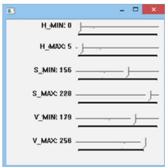
Slika 23: Podešavanje klizača za filtraciju crvene boje
