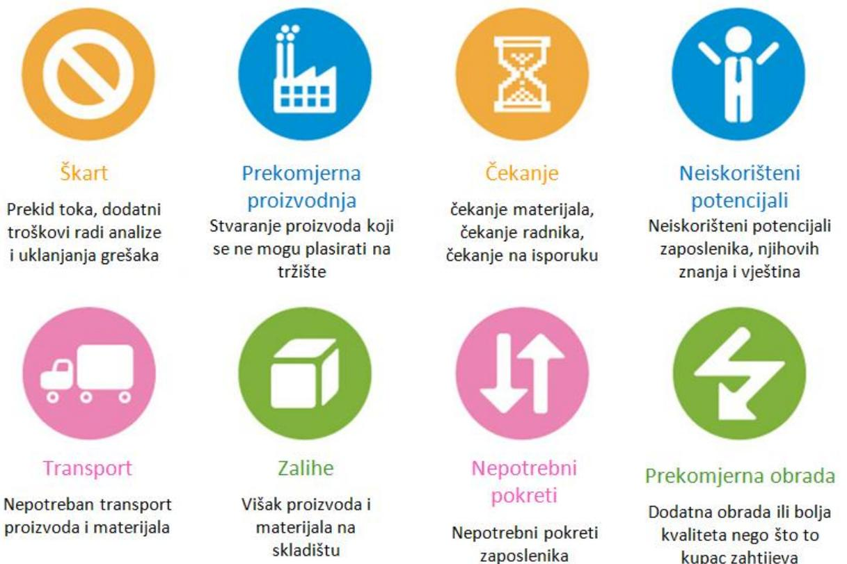
Slika 7. Osam tipova rasipanja u proizvodnji<sup>10</sup>
