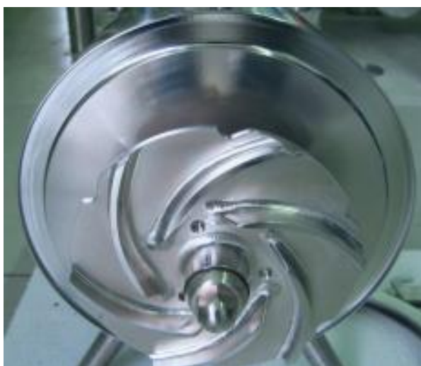
Slika 19. Propeler crpke sa prethodne slike nakon kemijskog čišćenja površine [22]
