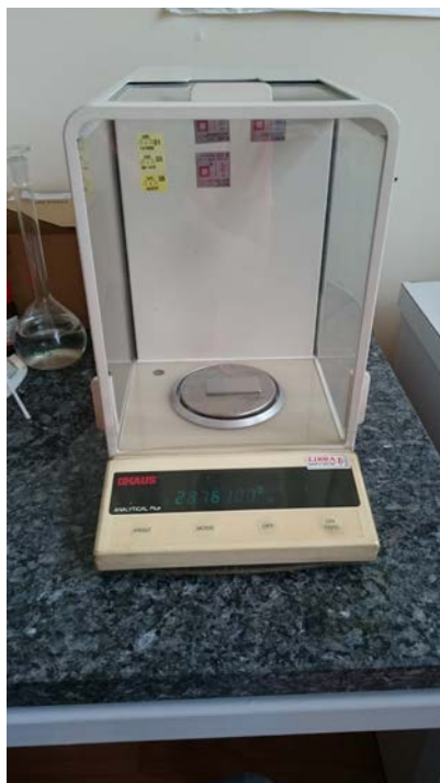
Slika 42. Vaganje uzorka preciznom analitičkom vagom
