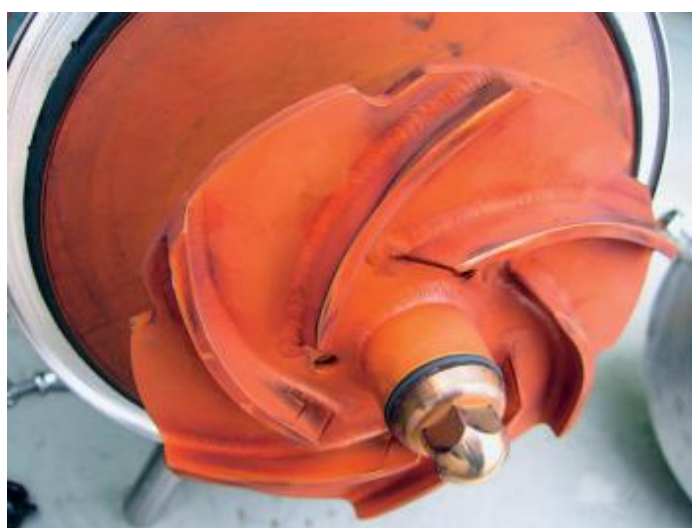
Slika 18. Pojava ružinga u obliku crvenog sloja oksida na površini propelera crpke od nehrđajućeg čelika [22]
