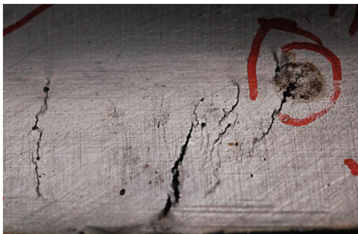
Slika 17. Pukotine izazvane napetosnom korozijom [20]
