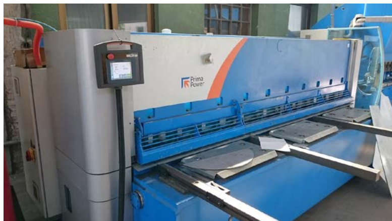
Slika 24. Hidrauličke CNC škare za rezanje lima [12]
