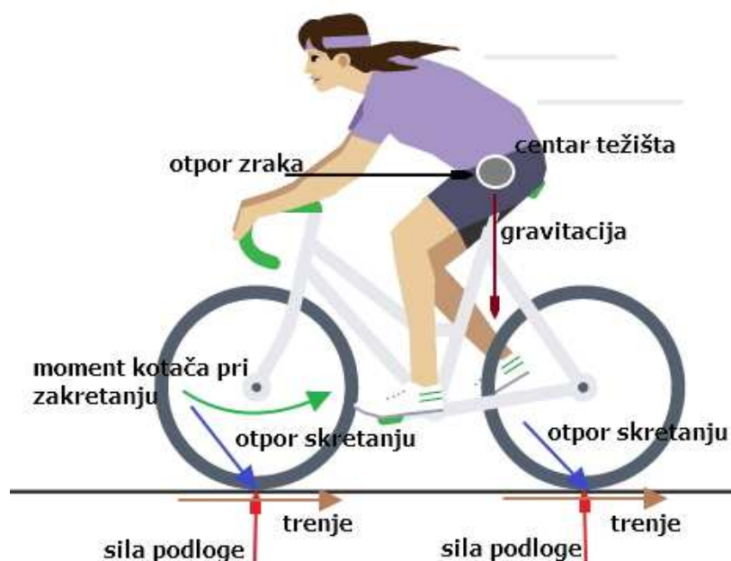
Slika 40. Komponente sile koje djeluju na sustav bicikl-vozač
