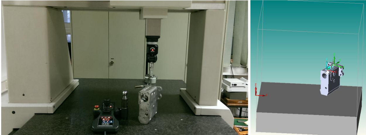
Slika 46 Usporedba pozicije objekta mjerenja u realnom i simulacijskom mjernom volumenu
