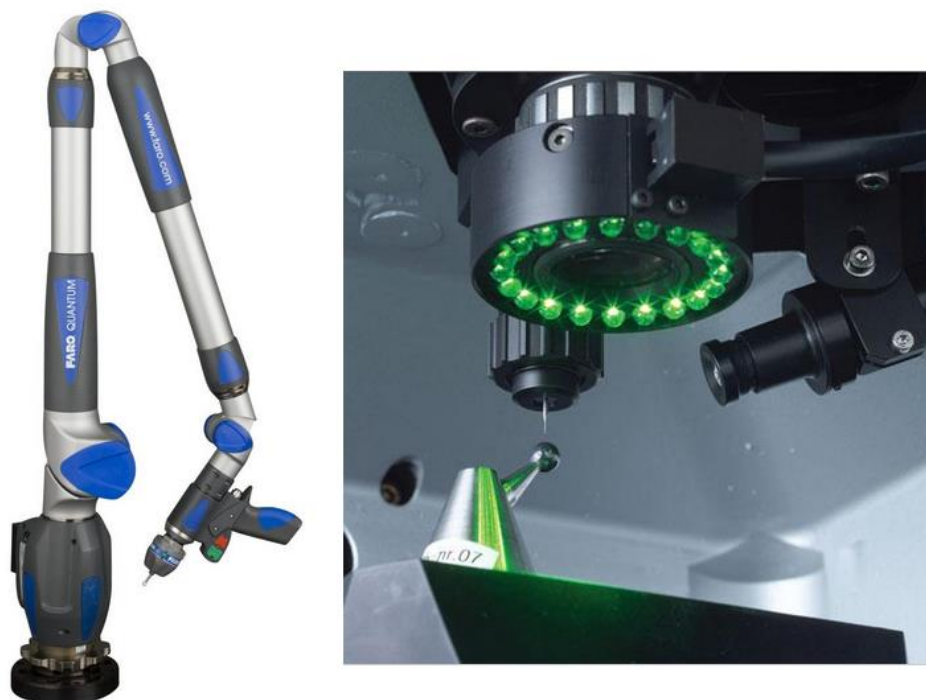
Slika 15 Moderni multisenzorski uređaji: Faro (Renishaw) i F25 (Zeiss)
