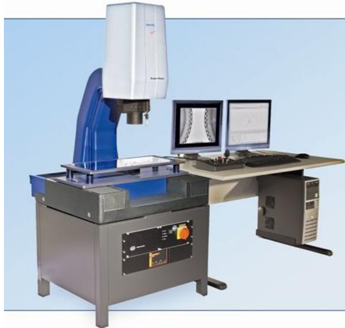
Slika 11 Mjerni uređaj s video ticalom
