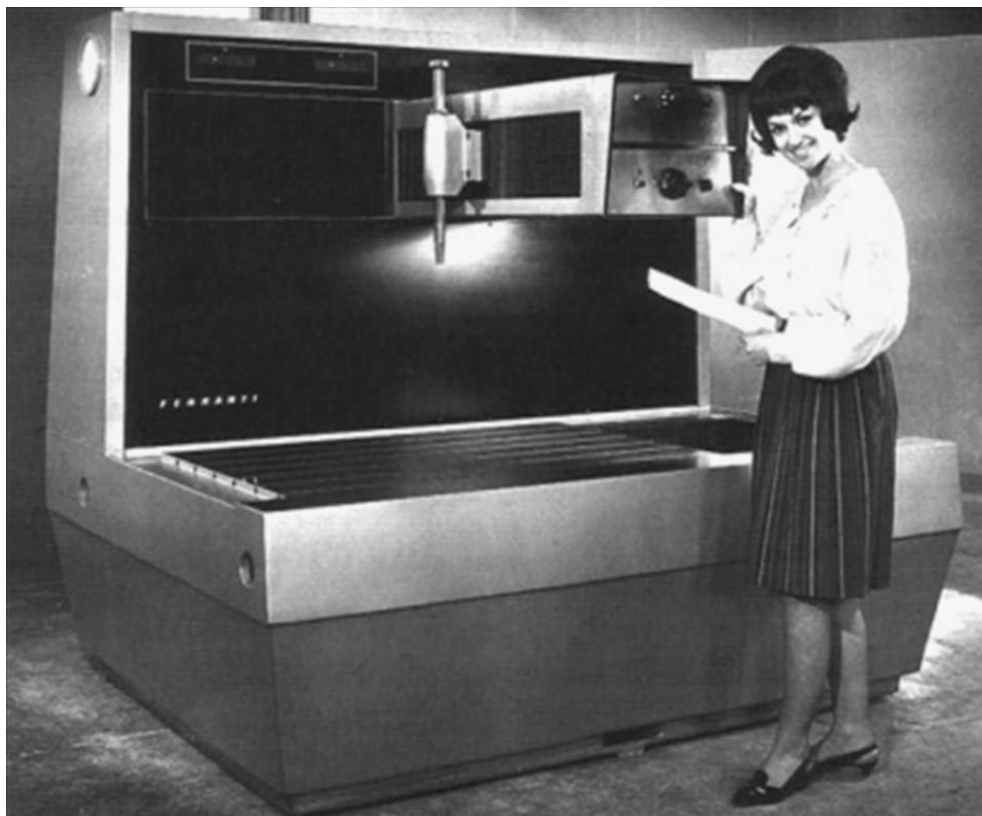
Slika 1 Trokoordinatni mjerni uređaj tvrtke Ferranti
