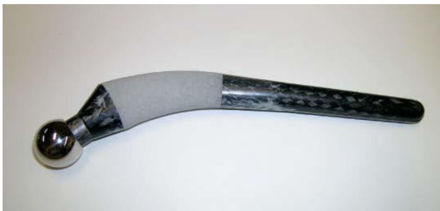
Slika 15. Umjetni kuk izrađen od kompozitnog materijala [10]
