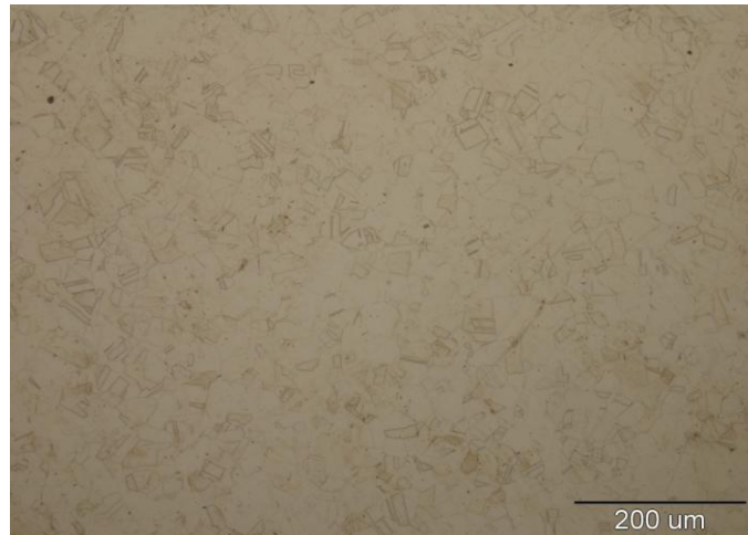
Slika 28. Mikrostruktura metalne glave (povećanje 200x)
