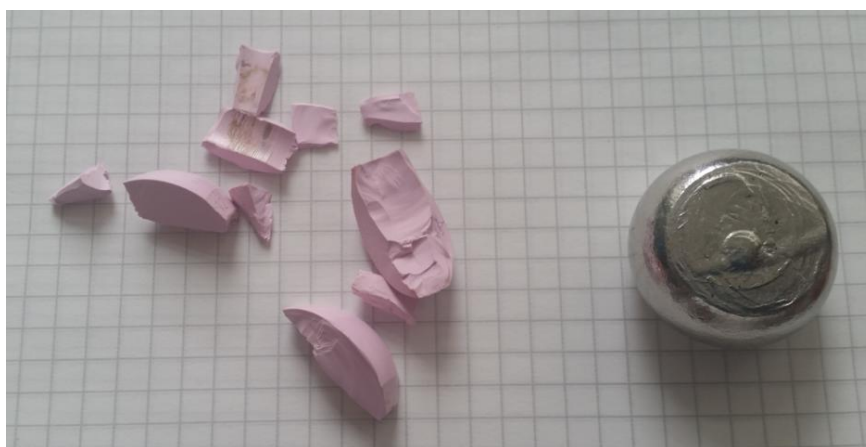
Slika 26. Prikaz glava kuka nakon tlačnog ispitivanja
