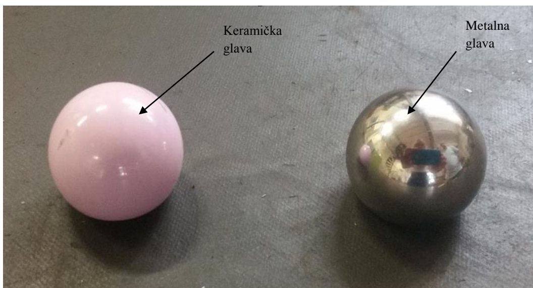
Slika 18. Prikaz keramičke i metalne glave
