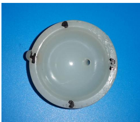
Slika 20. Polimerni uložak bez tribopara
