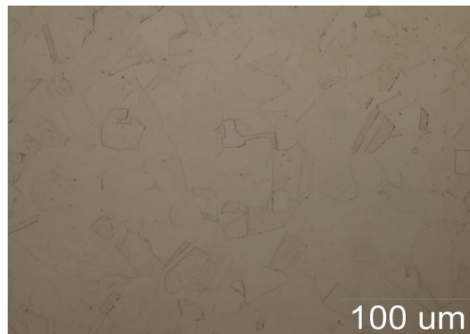
Slika 29. Mikrostruktura metalne glave (povećanje 500x)
