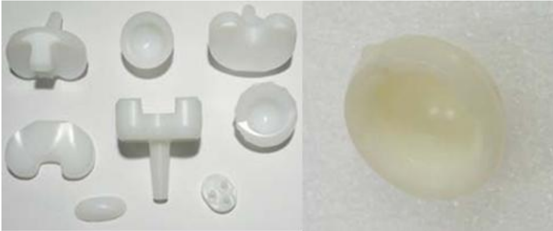
Slika 14. Dijelovi proteza od polietilena [10]
