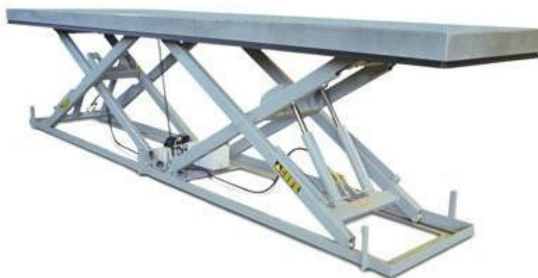
Slika 17. Serijska izvedba škarastog mehanizma
