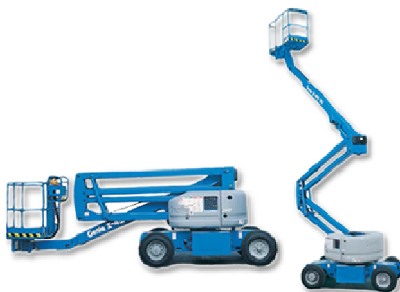
Slika 6. Radna platforma sa više spojenih paralelograma
