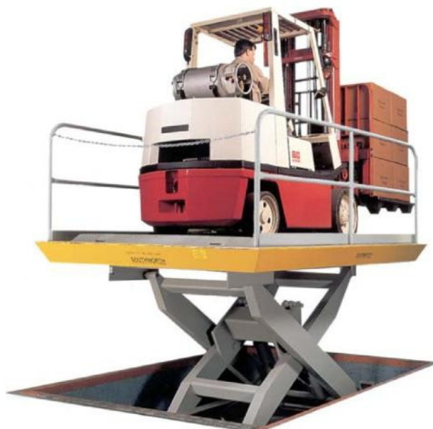
Slika 14. Ugradnja postolja u udubljenje
