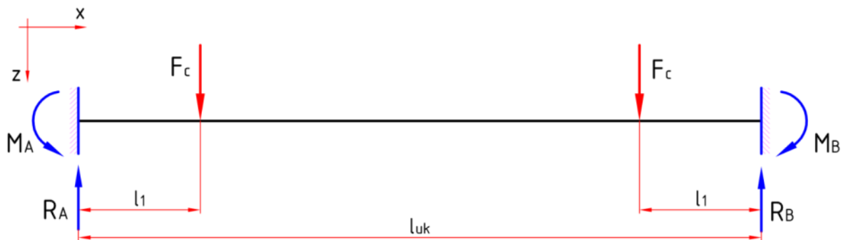
Slika 52. Opterećenje poprečne grede
