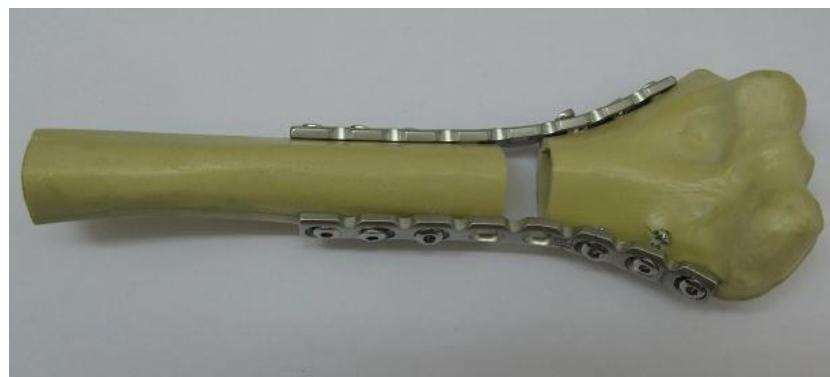
**Slika 27. Osteosinteza s dvije rekonstrukcijske pločice u paralelnoj konfiguraciji**
