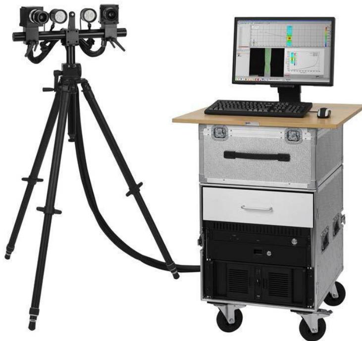
Slika 34. Optički mjerni sustav Aramis 4M [27]
