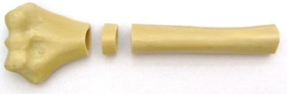
**Slika 26. Umjetni osteoporotični distalni humerus – stanje po osteotomiji**
