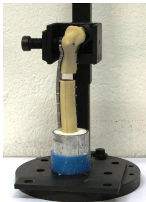
Slika 30. Model distalnog humerusa postavljen u napravi za fiksiranje i zaliven PMMA smjesom
