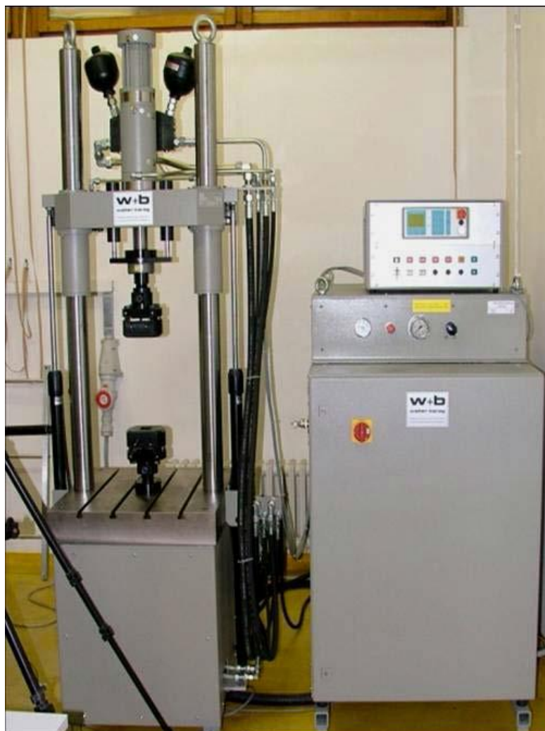
Slika 33. Umaralica Walter+Bai LFV 50-HH
