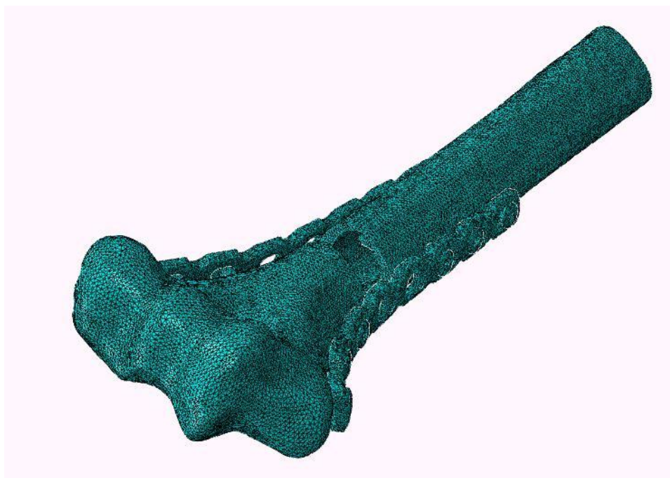
Slika 19. Mrežna konačnih elemenata na modelu s dvije rekonstrukcijske pločice u paralelnoj konfiguraciji
