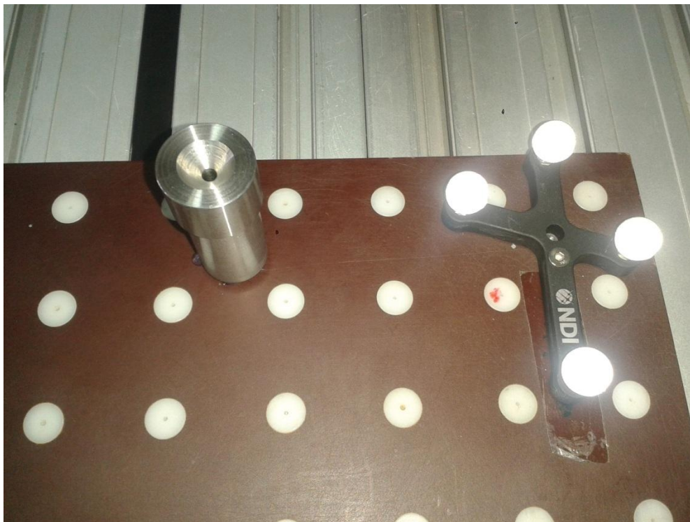
Slika 33. Čahura pričvršćena za kalibracijsku ploču.
