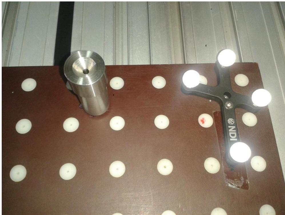
Slika 33. Čahura pričvršćena za kalibracijsku ploču.
