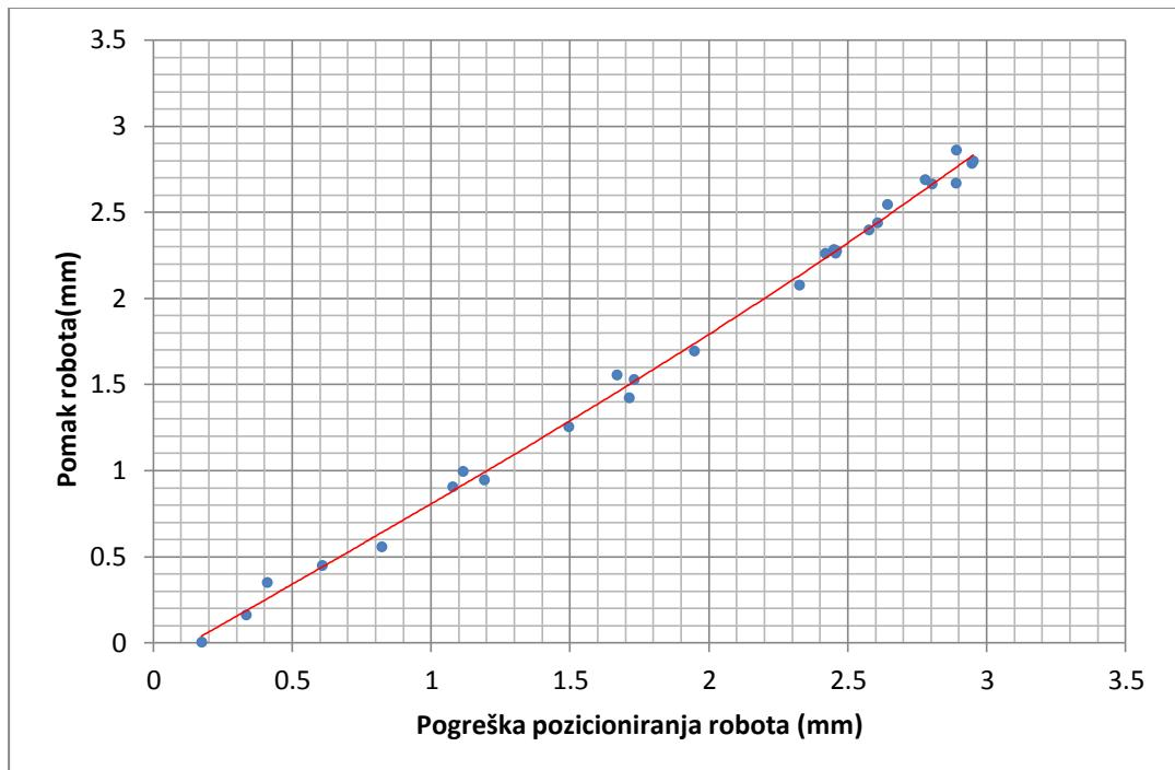
Slika 36. Prikaz pomaka robota u svrhu ispravljanja
