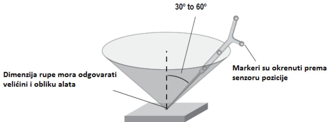
Slika 8. Tehnika pivotiranja alata [12]
