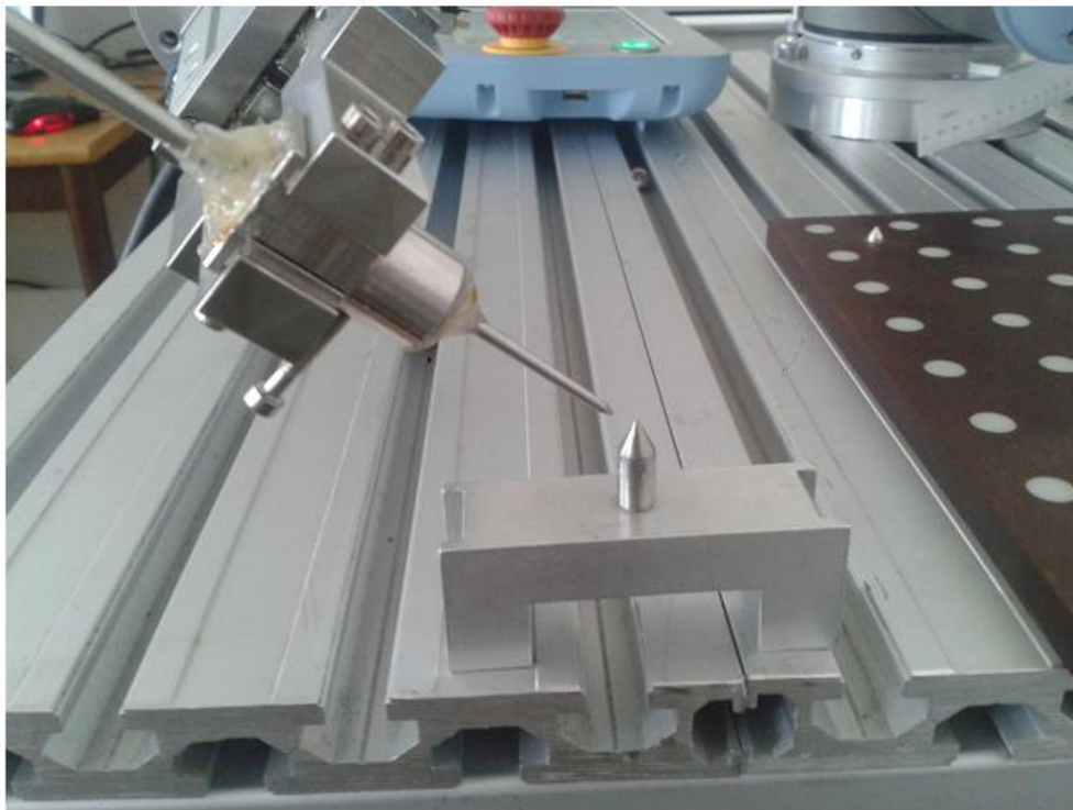
Slika 29. Kalibracija alata na robotu.
