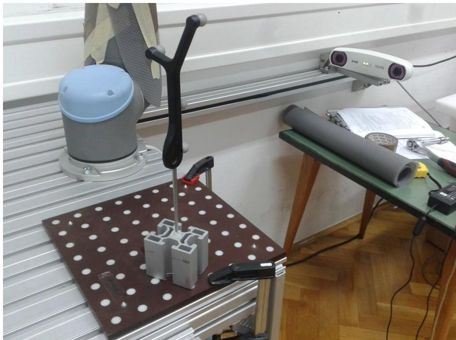
Slika 21. Ručno pomicanje sonde po kalibracijskoj ploči
