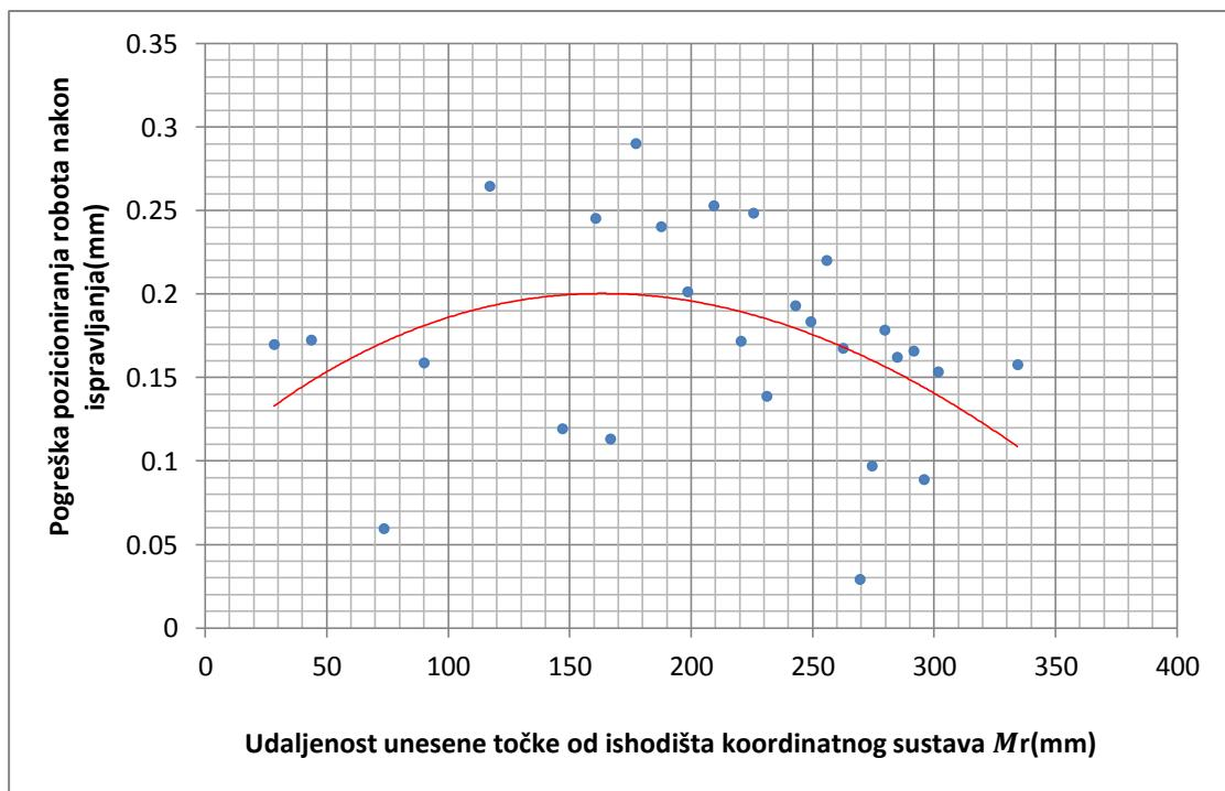
Slika 37. Smanjena pogreška pozicioniranja robota nakon ispravljanja
