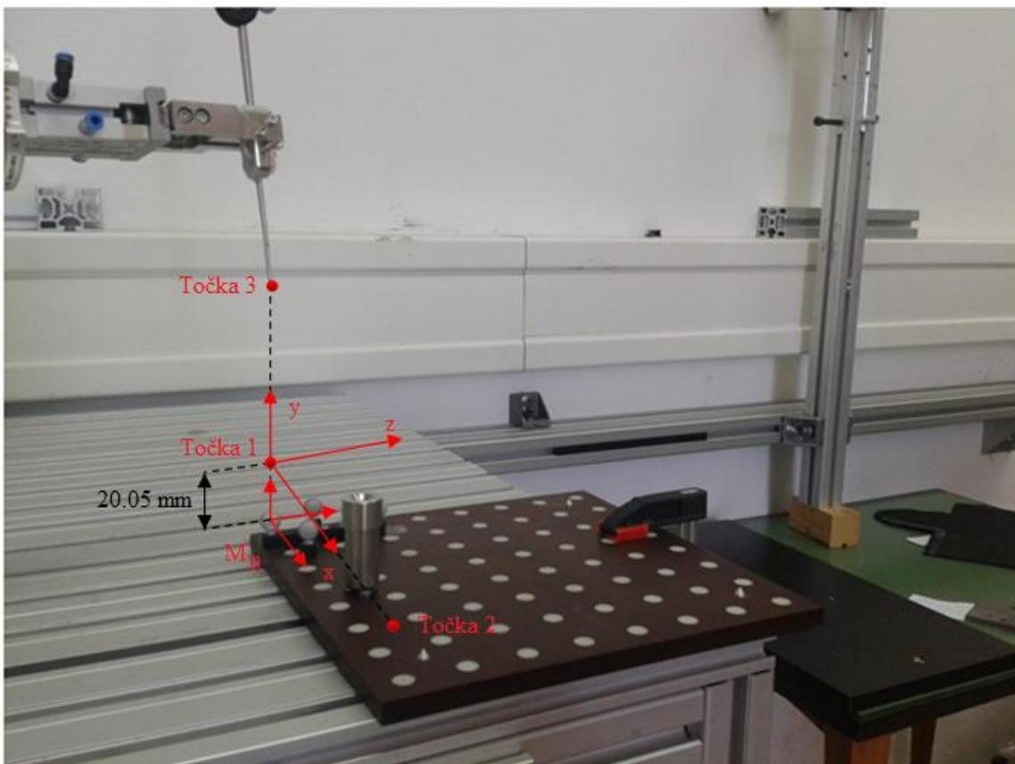
Slika 28. Definiranje novog koordinatnog sustava *Plane* na robotu
