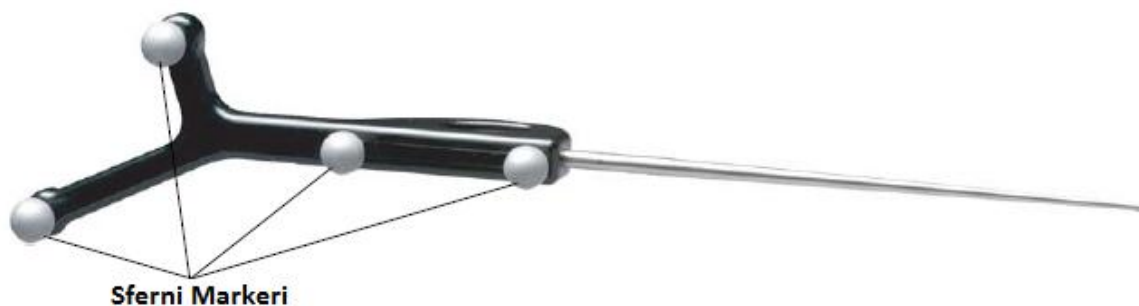
Slika 7. Sonda sa sfernim markerima [8]
