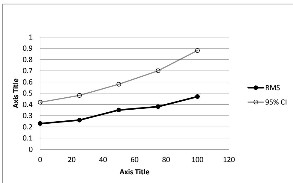
Slika 20. Smanjivanje točnosti uslijed povećanja udaljenosti vrha alata.[18]
