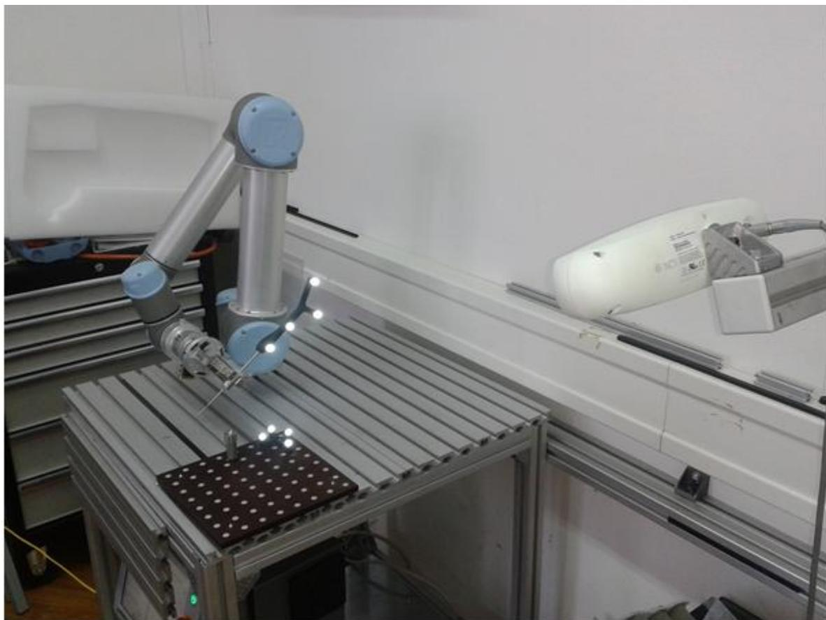
Slika 24. Markeri sa reflektirajućim sfernim kuglama
