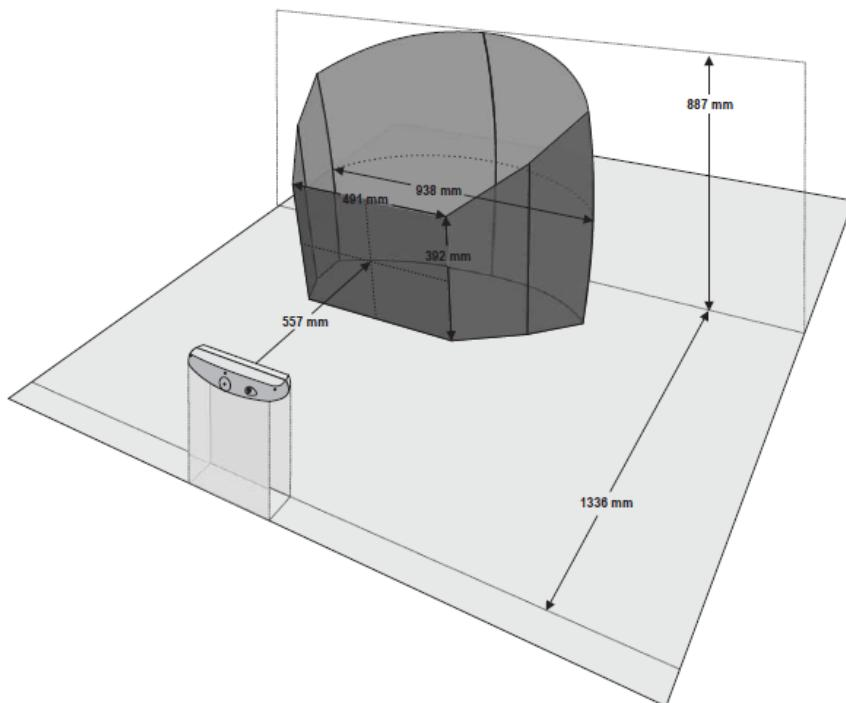
Slika 5. Trodimenzionalni prikaz mjernog volumena Polaris Vicra sistema[12]
