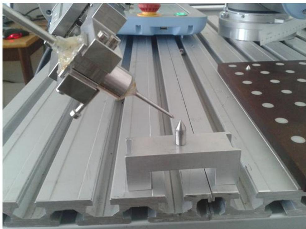
Slika 29. Kalibracija alata na robotu.
