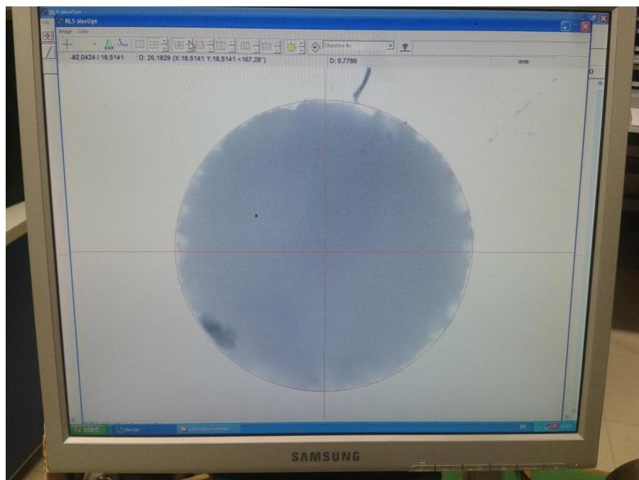
Slika 18. Precizno određivanje središta rupe na ploči
