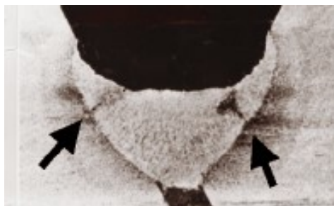
Slika 24. Pukotina uzrokovana prevelikim sadržajem sumpora u OM [20]
