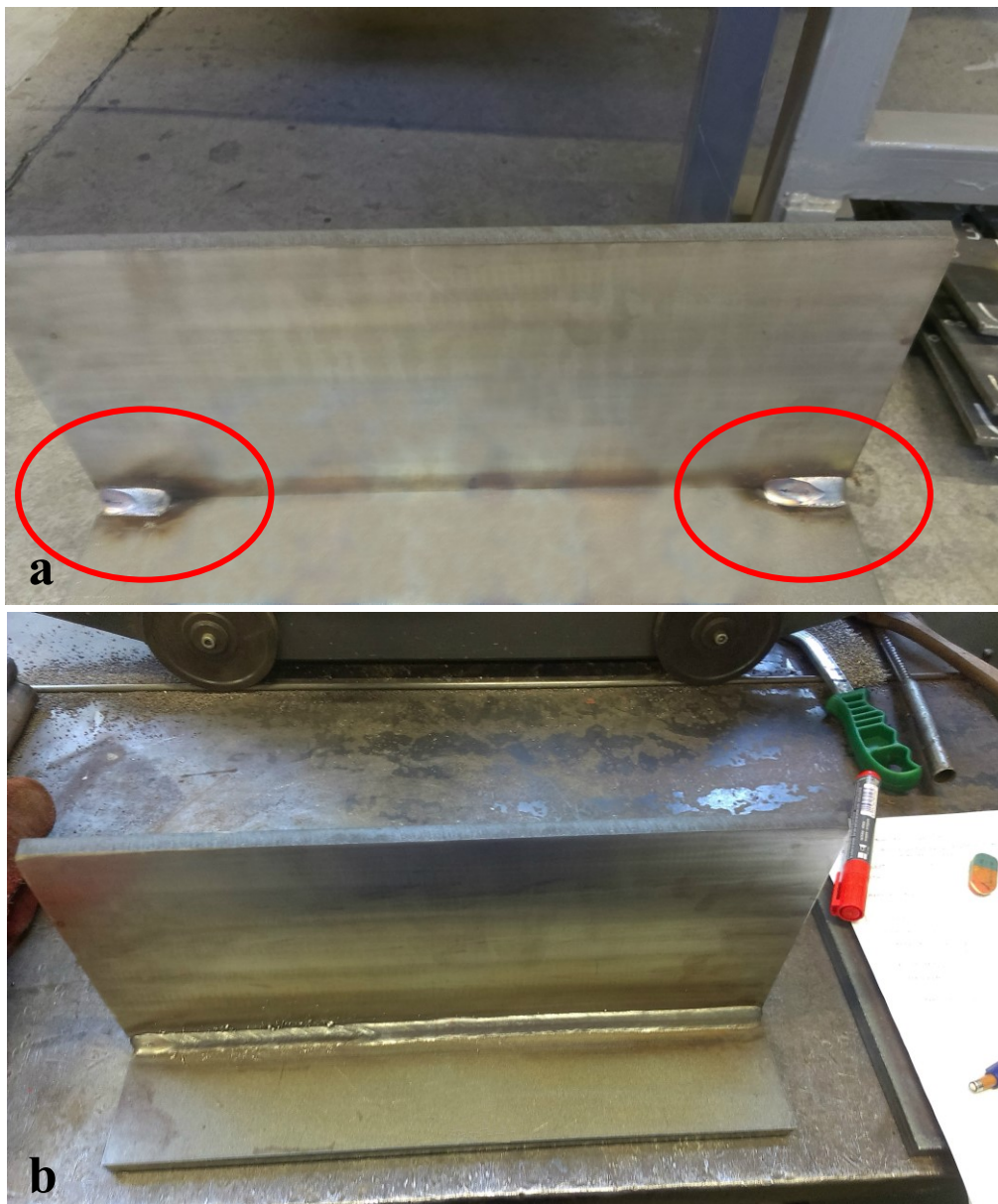
Slika 47. Način ukrućenja ispitnih uzoraka
