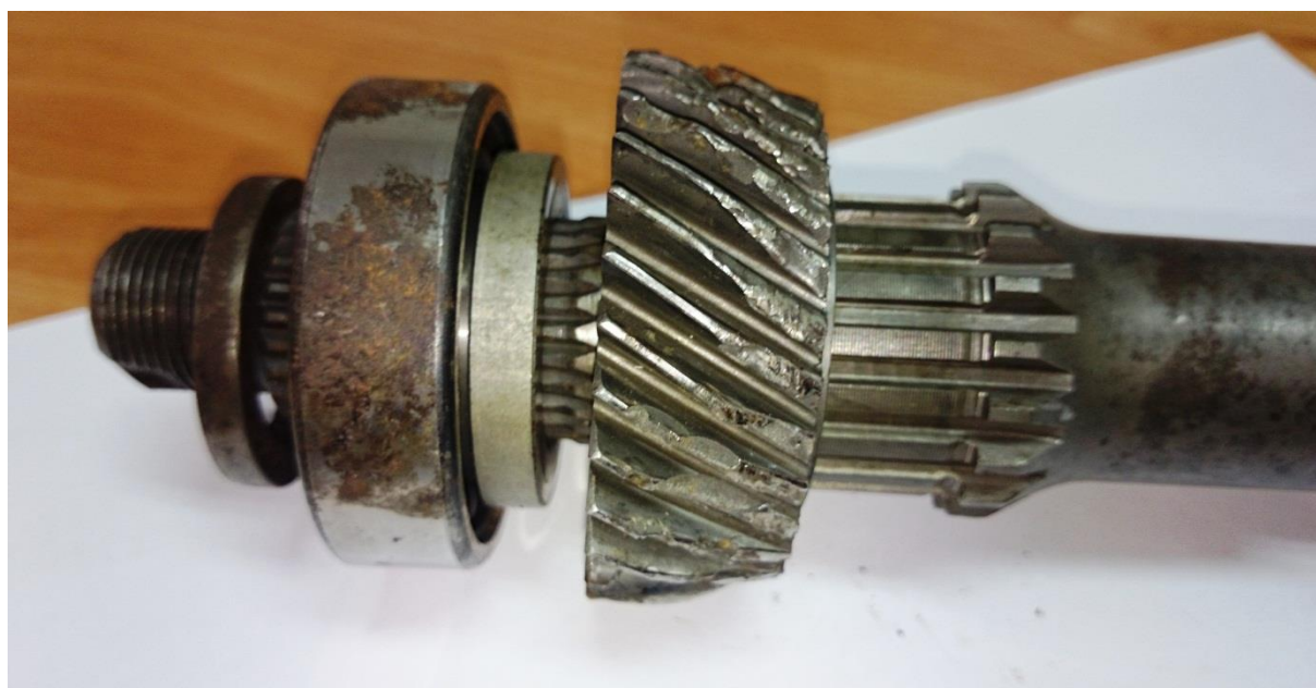
Slika 37. Izvađeni zupčanik reduktora
