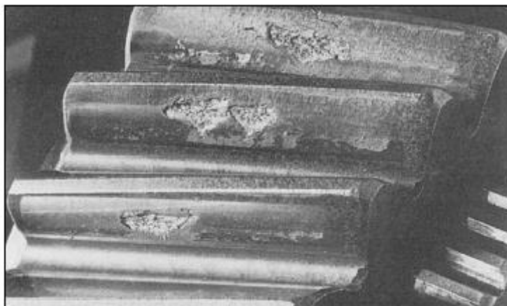
Slika 31. Odvajanje manjih dijelova ( Spalling ) [27]
