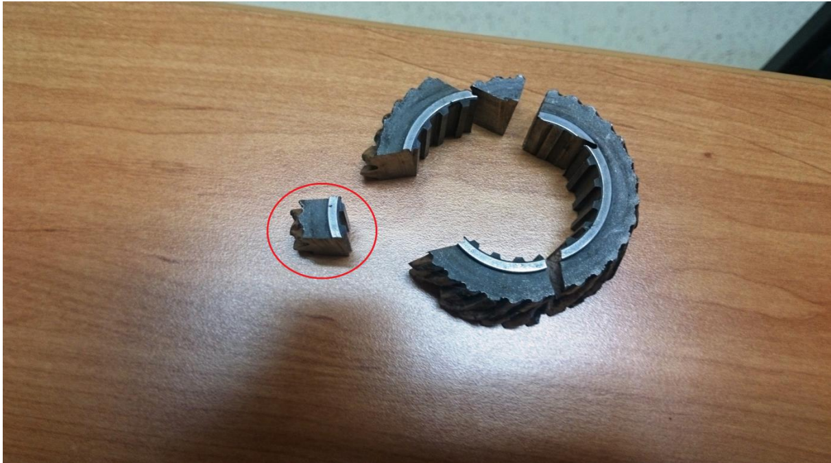
Slika 42. Izrezan uzorak zupčanika reduktora
