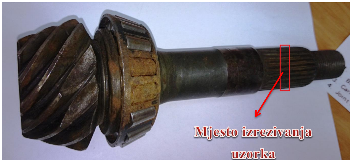
Slika 40. Mjesto izrezivanja uzorka osovine
