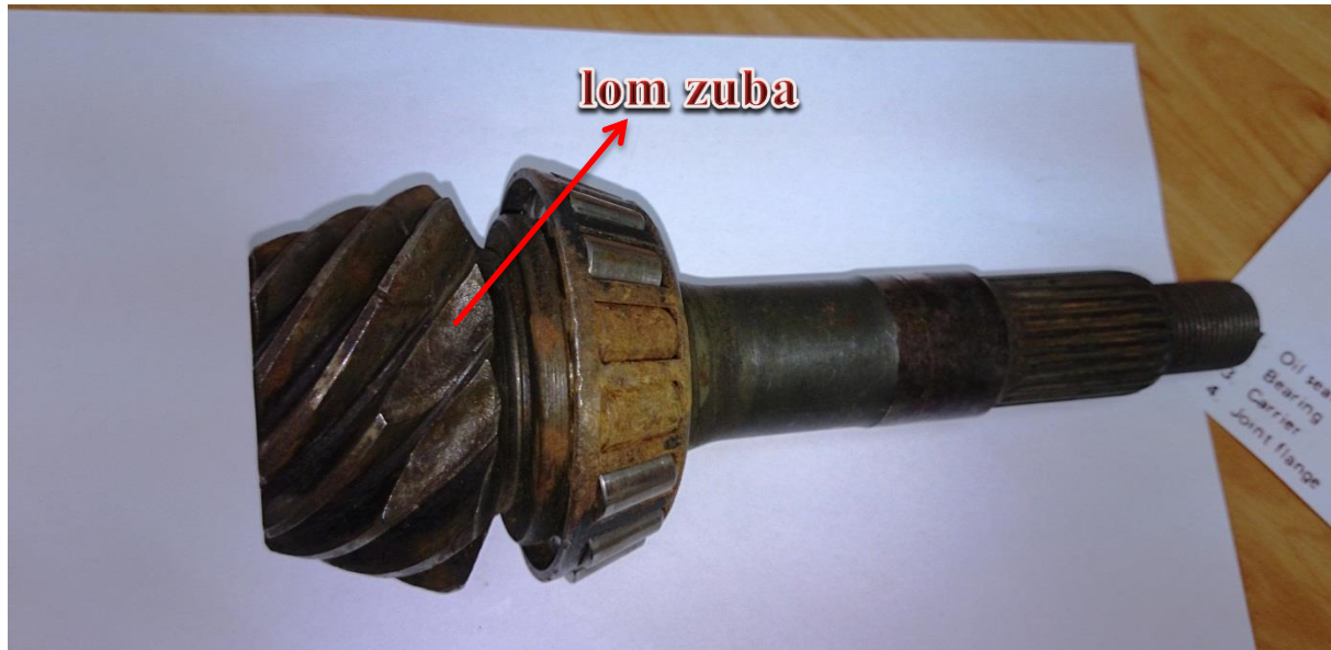
Slika 38. Lom zuba zupčanika stražnjeg diferencijala
