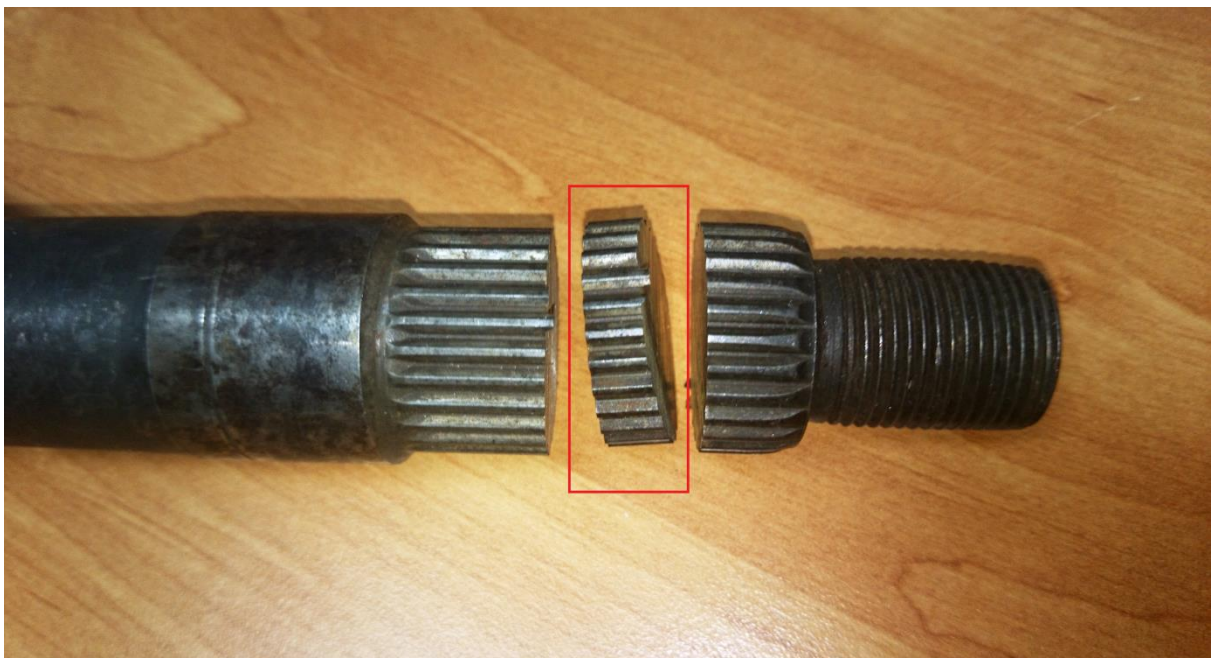
Slika 43. Dobiveni uzorak nakon izrezivanja osovine diferencijala
