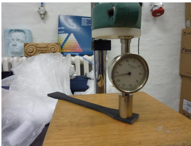
Slika 4.12. Mjerenje tvrdoće ispitnog tijela
