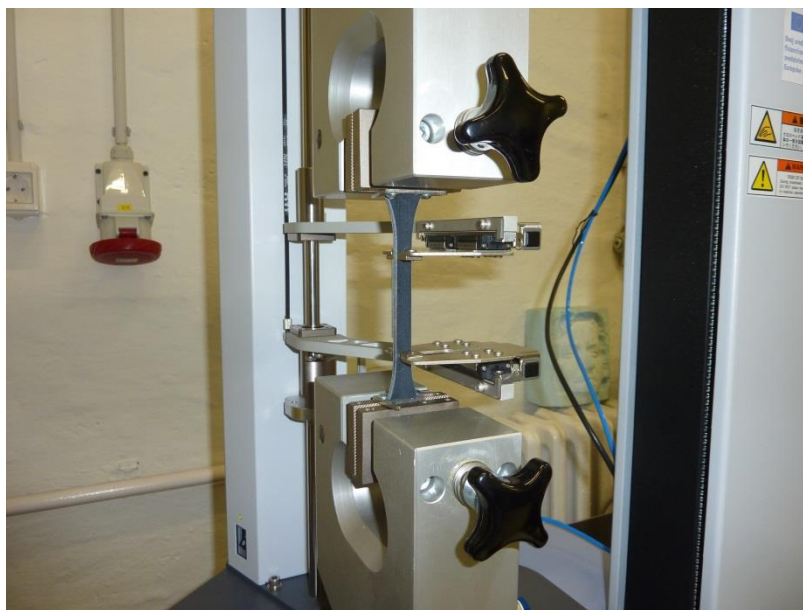
Slika 4.9. Čeljusti za ispitivanje rasteznih svojstava
