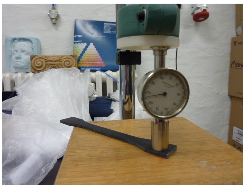
Slika 4.12. Mjerenje tvrdoće ispitnog tijela
