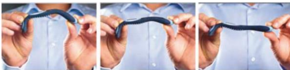
Slika 3.15. Isprobavanje krutosti držača britvica [15]
