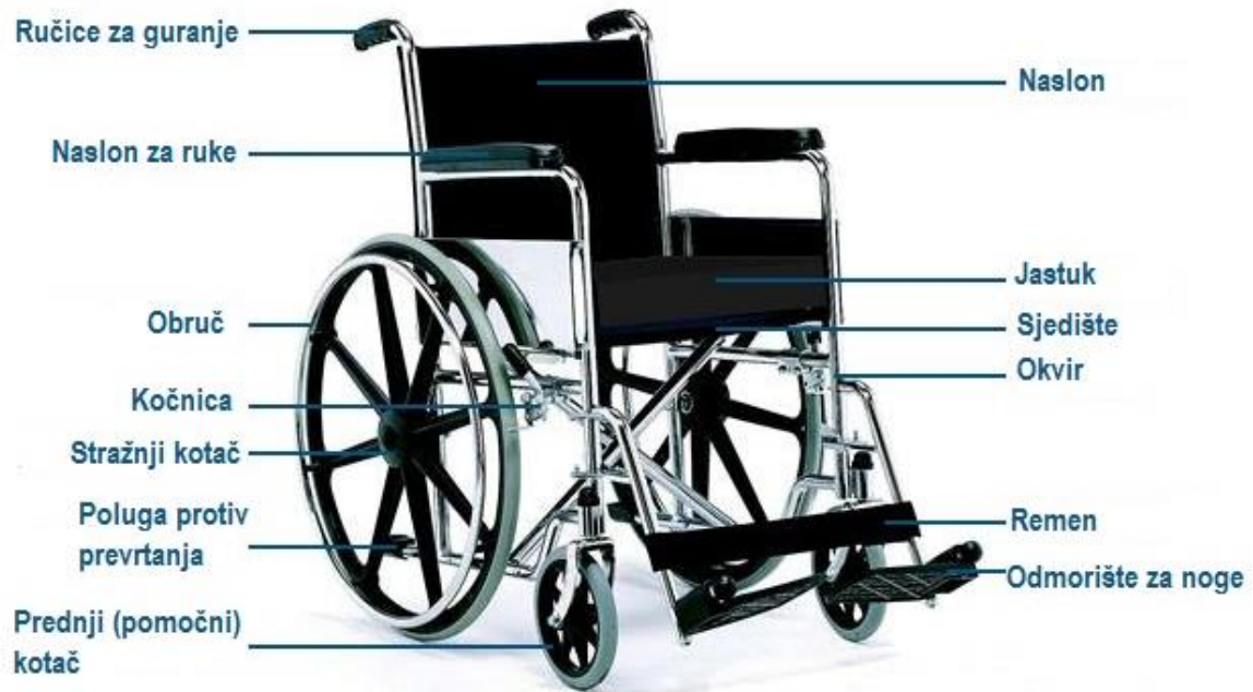
Slika 12. Elementi sklopivih invalidskih kolica
