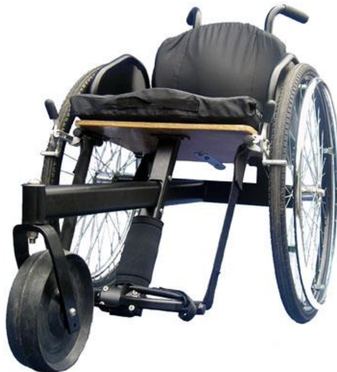
Slika 19. WM3 – 01 - invalidska kolica za neravne terene [16]
