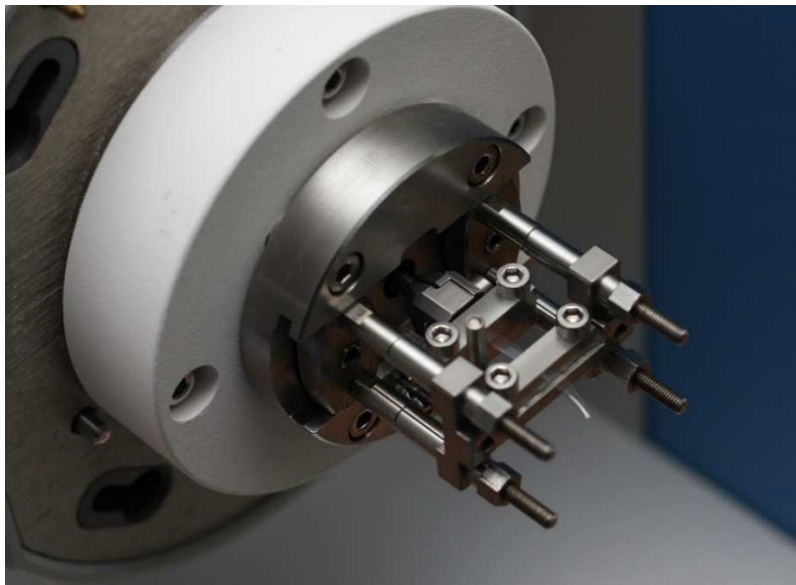
Slika 5.8. Prihvat ispitnih tijela na uređaju TT DMA [14]
